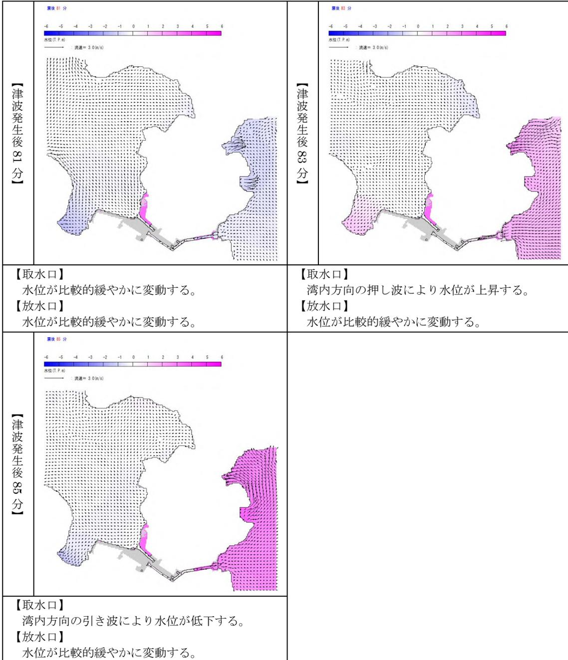
図 5 (6/6) 基準津波 1 の流速及び流向
