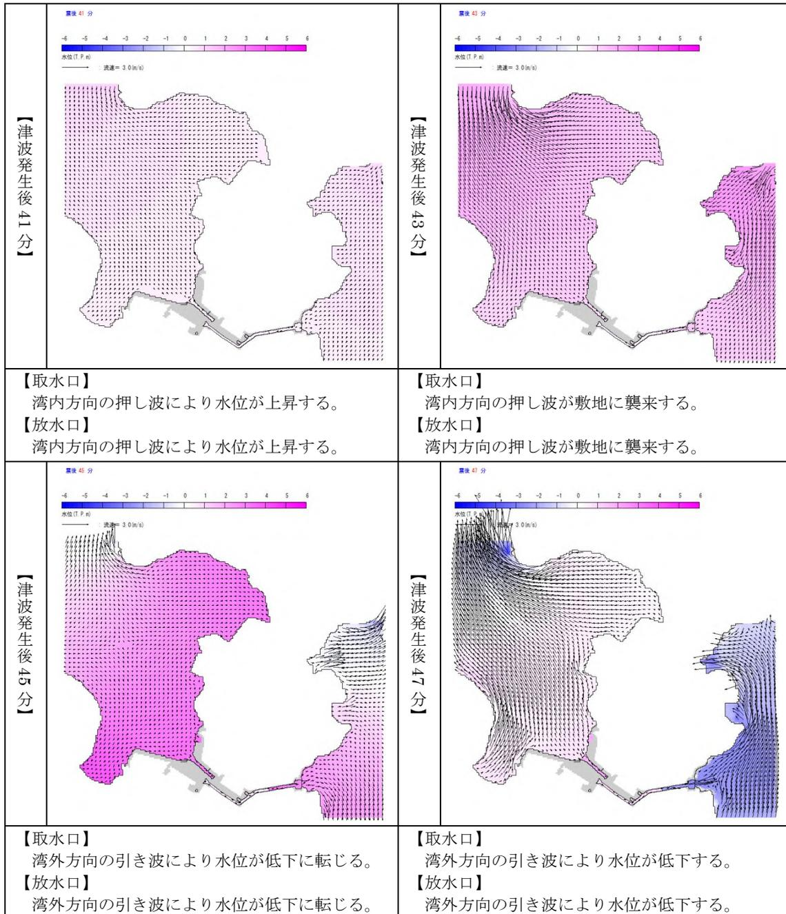
図 5 (1/6) 基準津波 1 の流速及び流向
