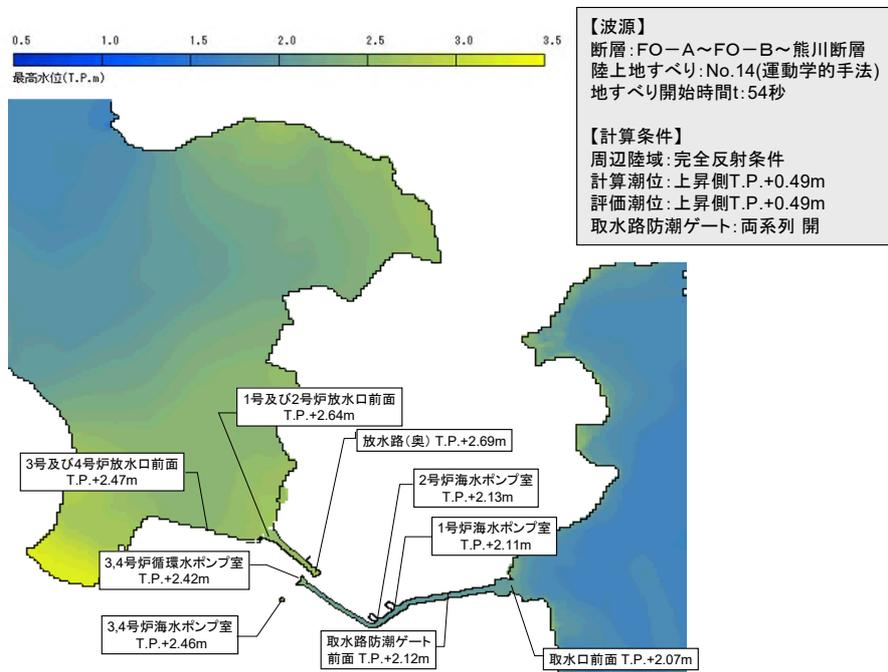
図2 最大水位上昇量分布図 (基準津波2)
