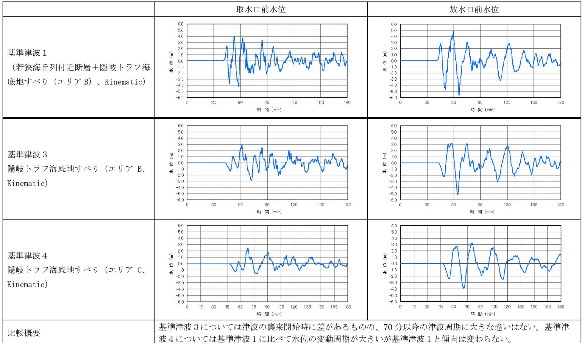
図 1 基準津波の波形の比較
