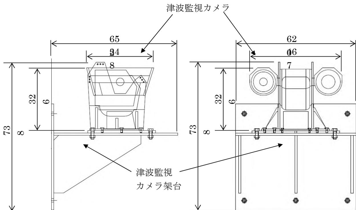
図 3-3-3 津波監視カメラ外形図
