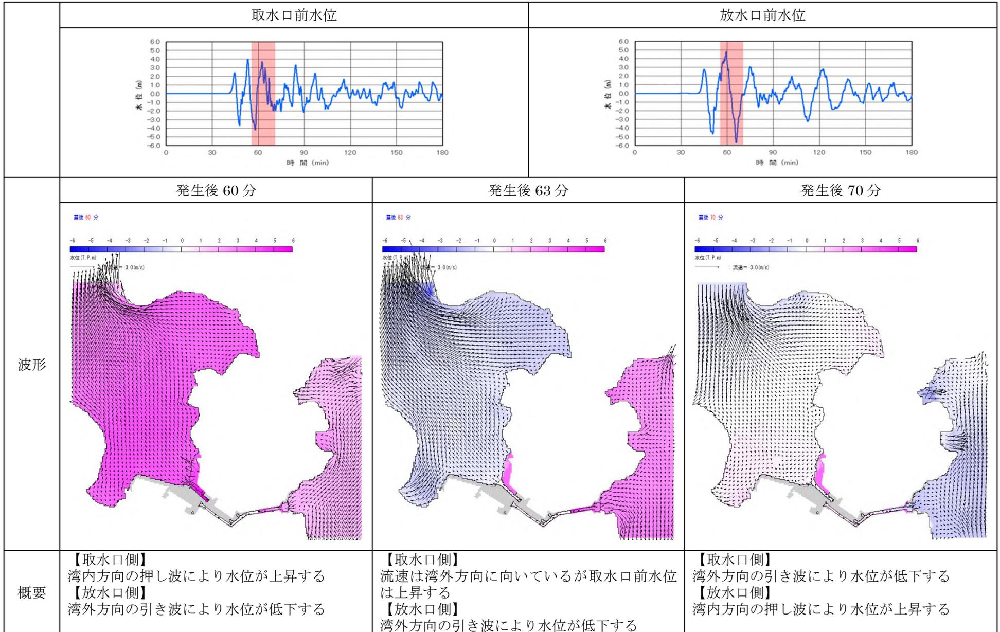
図 2 (3/3) 基準津波 1 の流向・流速の概要
