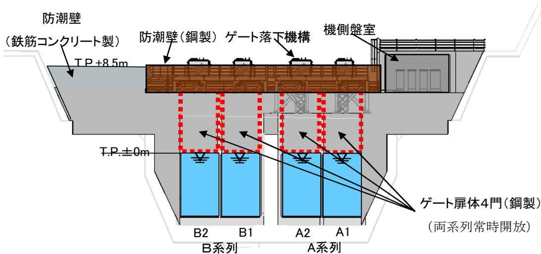
図-3-1-2 取水路防潮ゲート断面図
