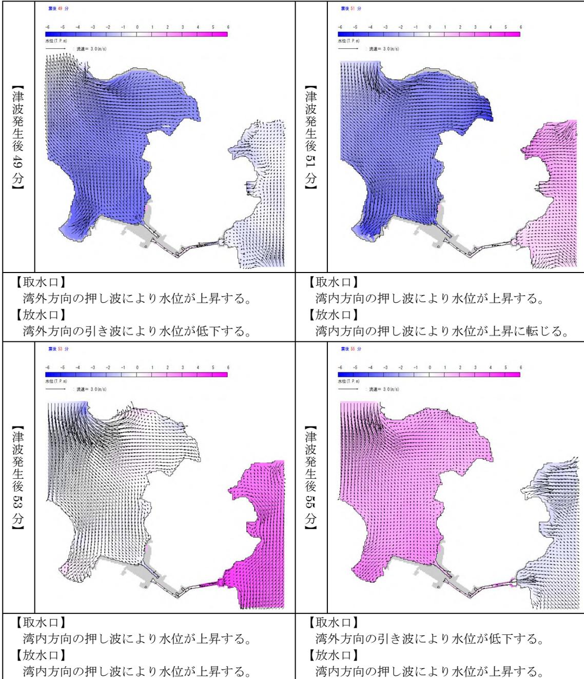
図 5 (2/6) 基準津波 1 の流速及び流向
