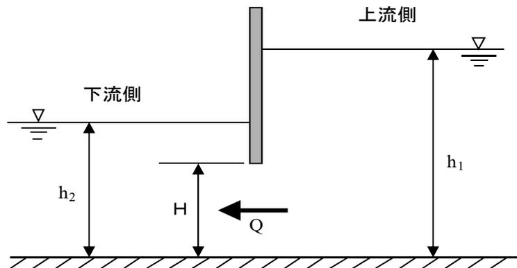
$h_1$ 、 $h_2$ : 施設前後の水位 (m)  $H$ : 開口部高さ (m)  $Q$ : 流量 ( $m^3/s$ )
