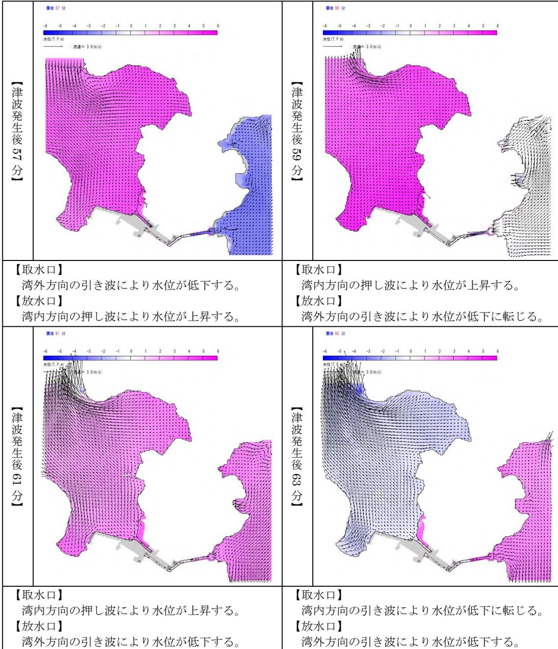
図 5 (3/6) 基準津波 1 の流速及び流向
