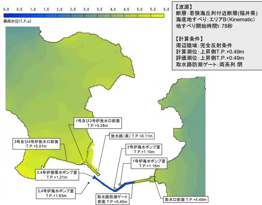
図1 最大水位上昇量分布図 (基準津波1)
