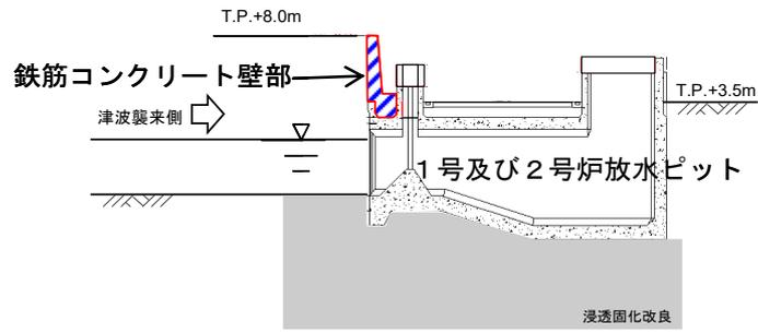
図-3-1-7 鉄筋コンクリート壁部
