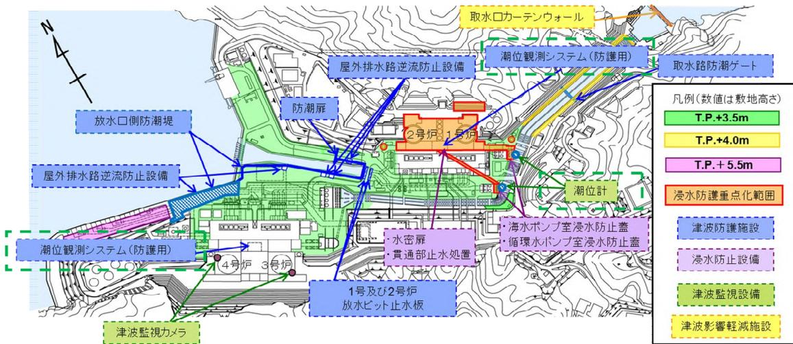
図-1 高浜発電所1号炉及び2号炉における津波防護対策の概要
