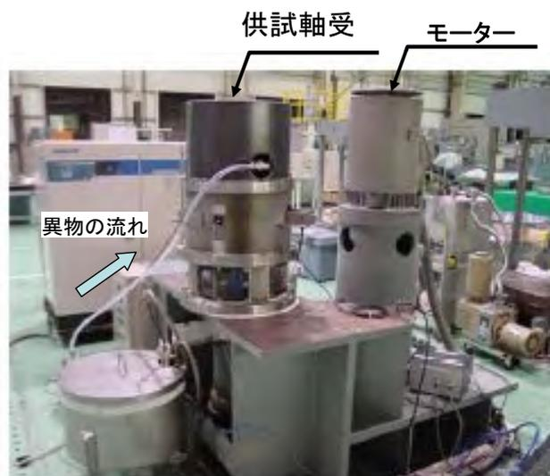
図-2 海水ポンプ軸受摩耗試験装置
