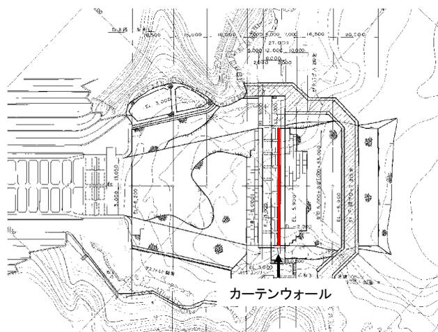
図-3-4-1 取水口カーテンウォール平面図
