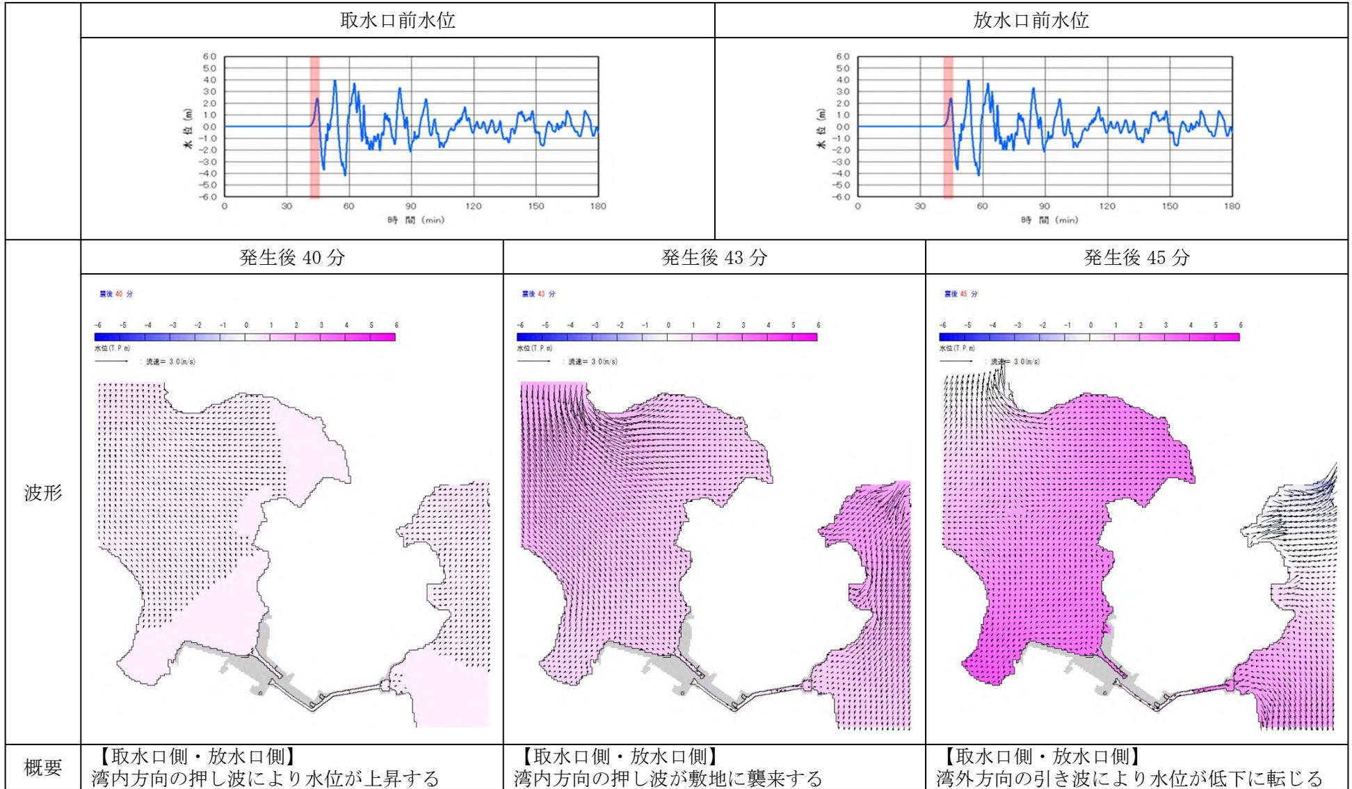
図 2 (1/3) 基準津波 1 の流向・流速の概要
