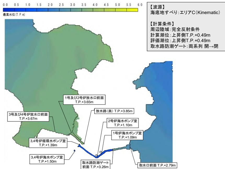
図4 最大水位上昇量分布図 (基準津波4)
