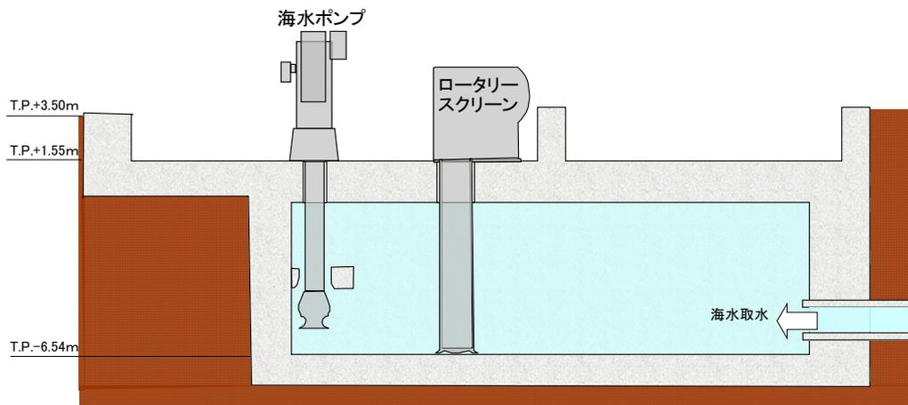
図-2-5-44 除塵装置概略図
