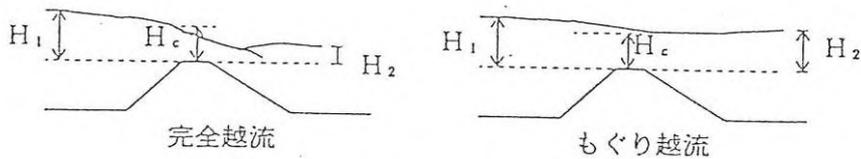
図-5 取水口及び放水口のカーテンウォール(1/2)
