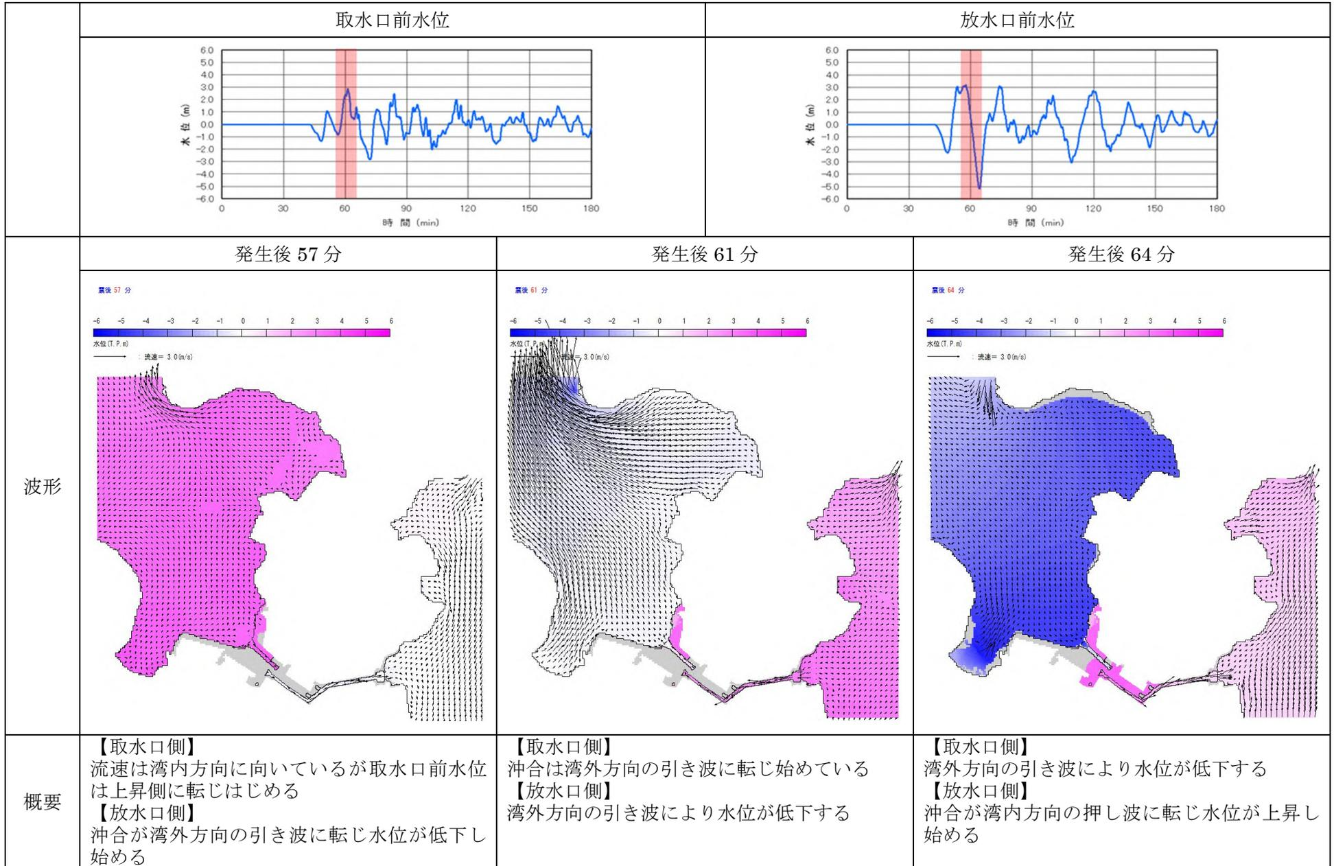
図3 (2/3) 基準津波3の流向・流速の概要
