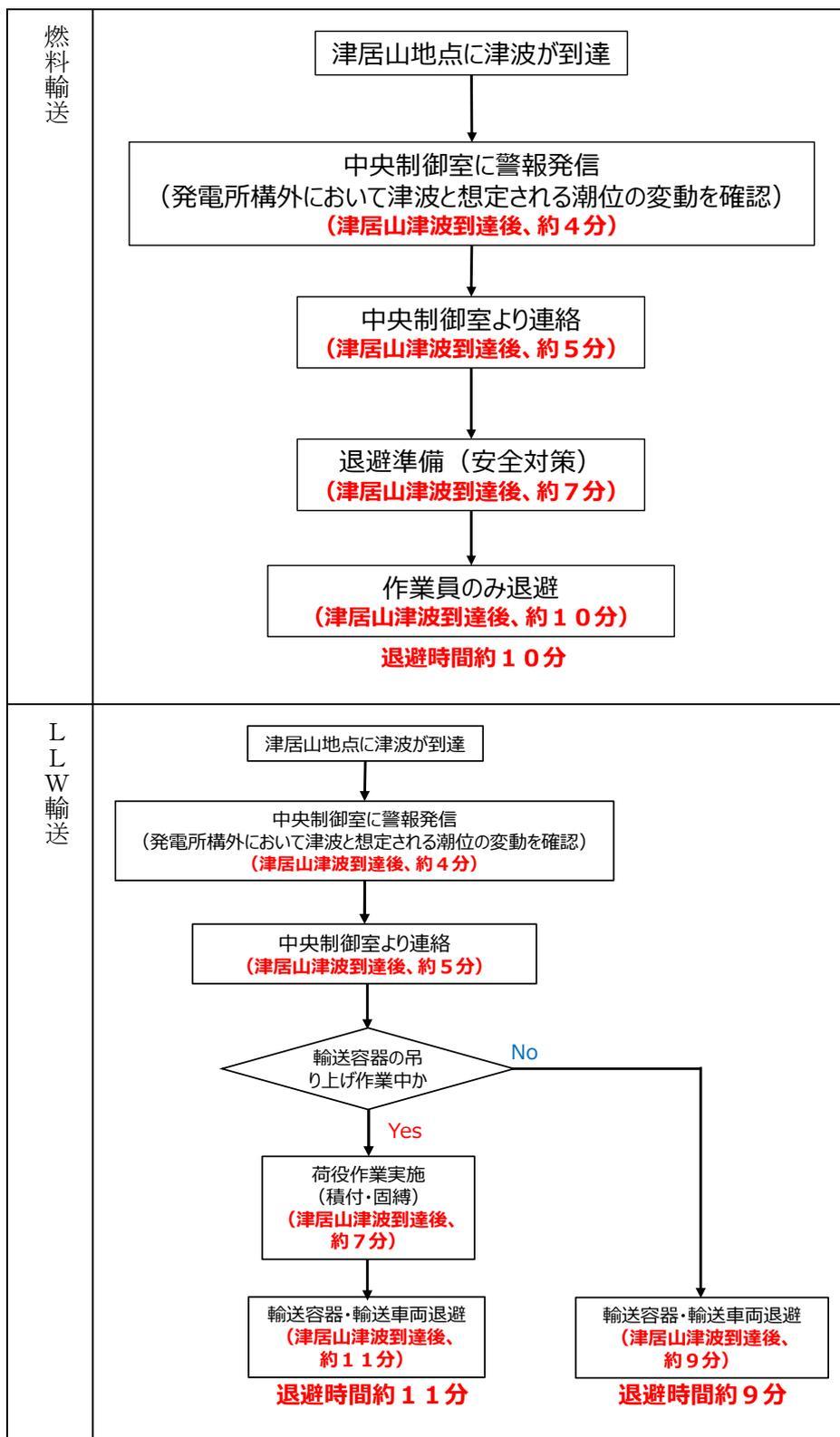
図7 陸側にある輸送物の退避の考え方
