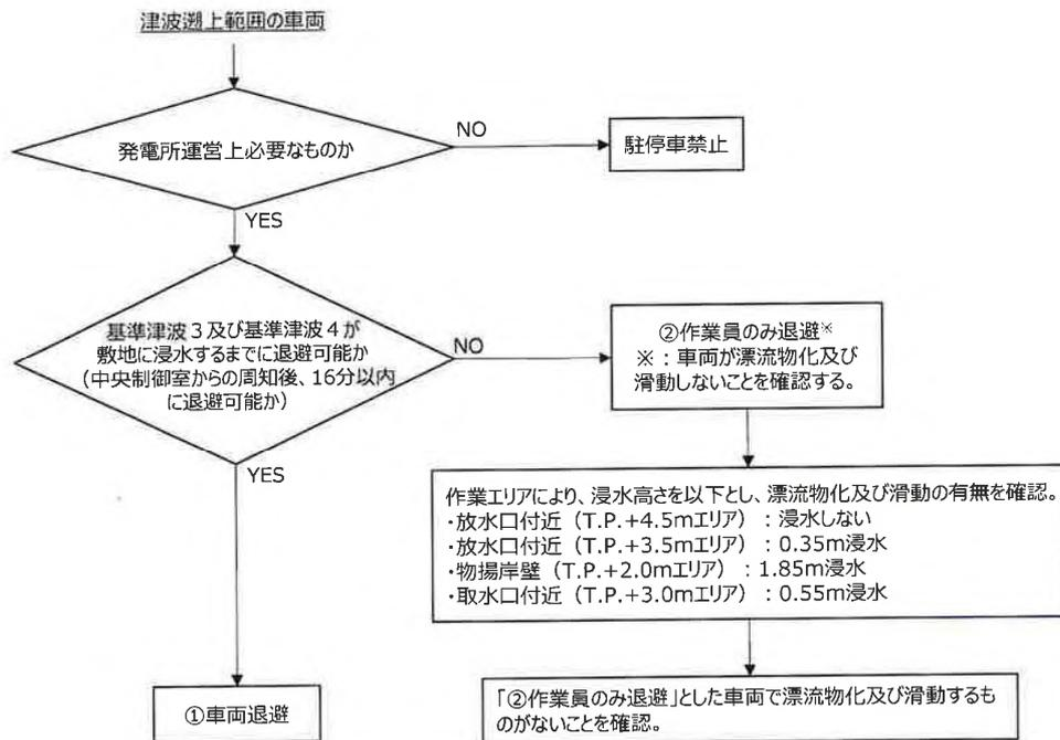
図4 津波遡上範囲の車両の分類フロー
