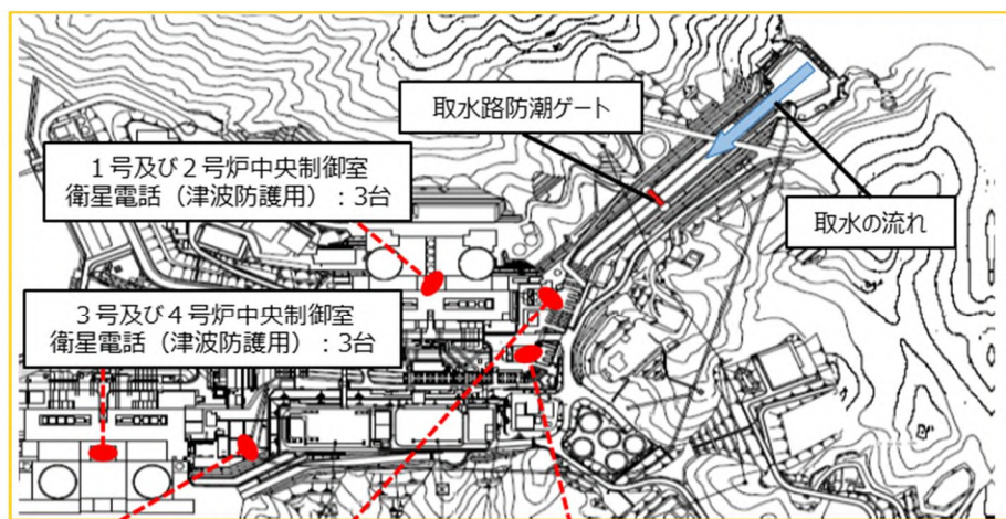
図28 潮位観測システム（防護用）の設置位置図
