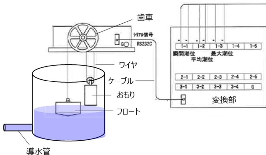
図3 潮位計の概要図（イメージ）
