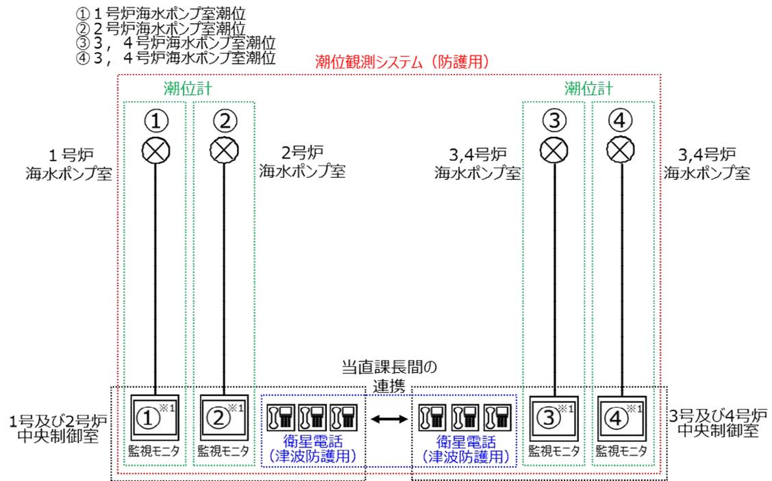
※ 1 : 電源箱及び演算装置は監視モニタの盤内機器であり、監視モニタの一部である。
