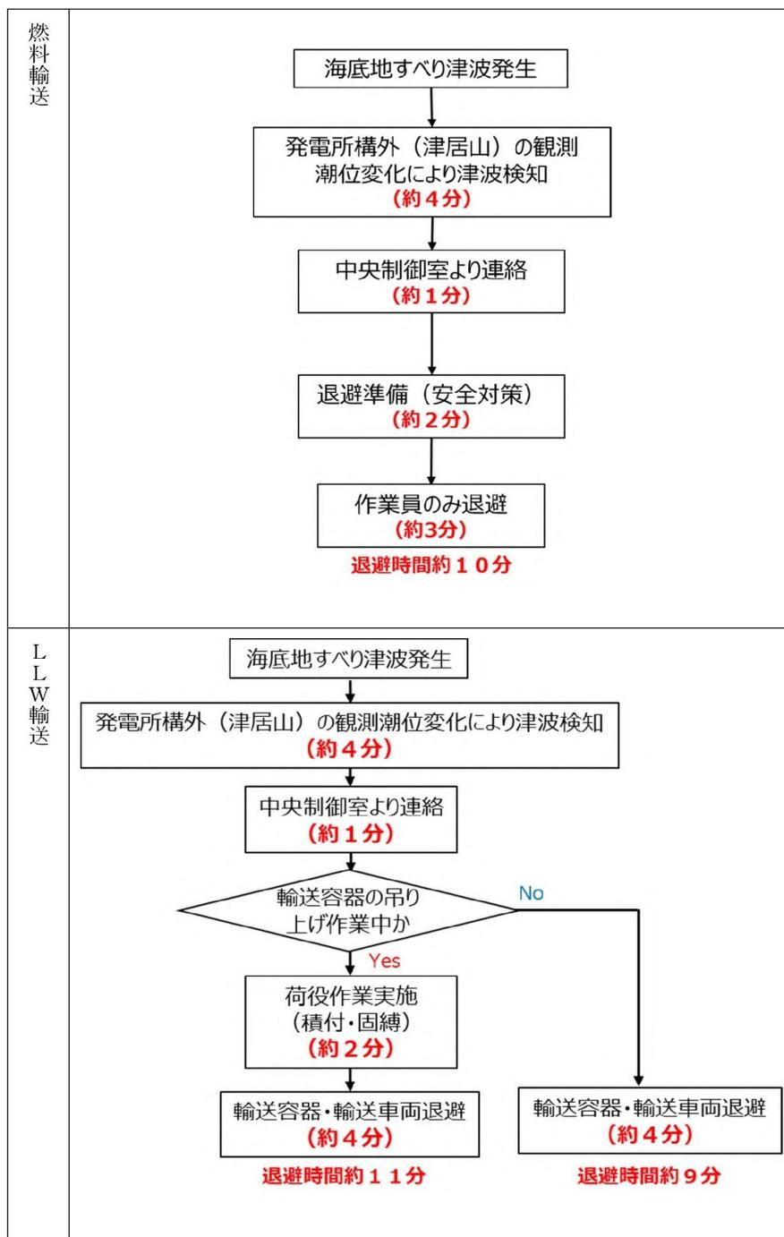
図 7 陸側にある輸送物の退避の考え方
