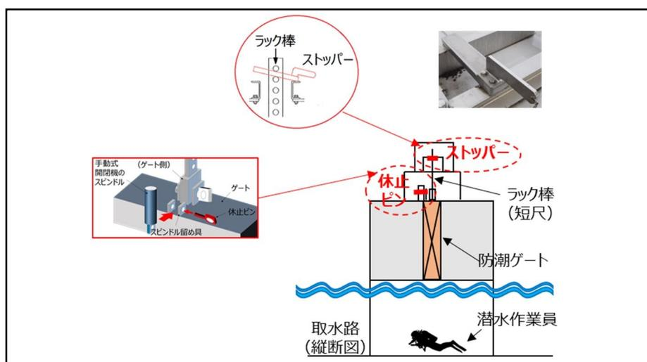
図2 取水路防潮ゲートの落下防止処置
