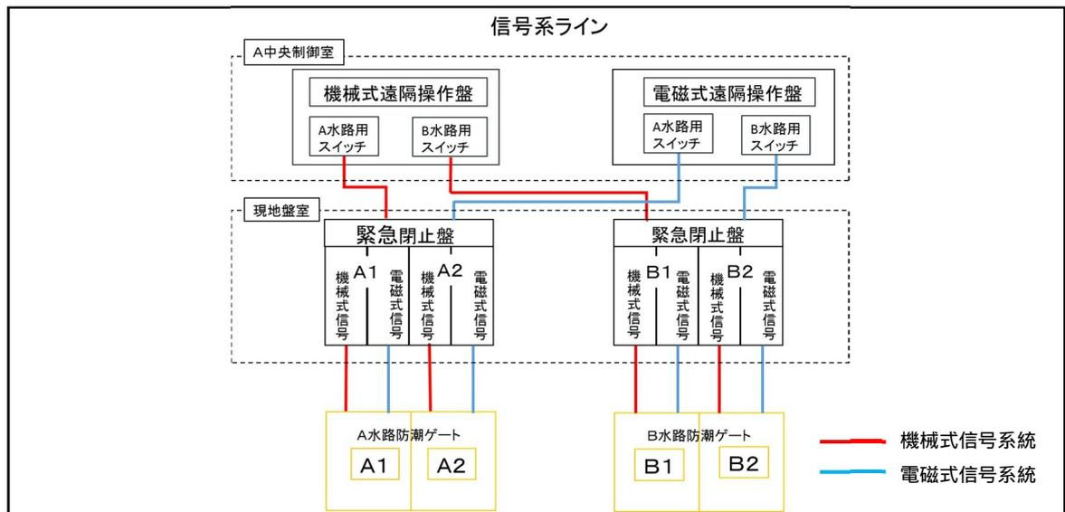
図1 遠隔閉止信号によるゲート落下機構の概念図
