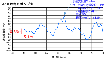
図 1 1 崩壊規模のパラメータスタディ結果 (津波襲来の判断基準（トリガー）による検知可否の確認)
