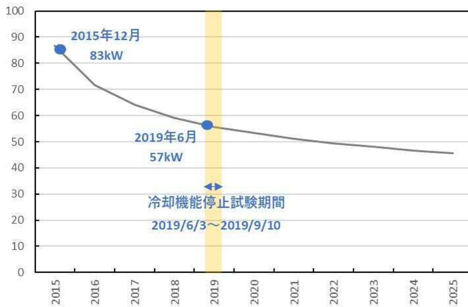
図1 敦賀発電所1号炉 使用済燃料の崩壊熱推移
