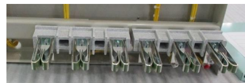
ユニットの差込み接続箇所 (裏面)
