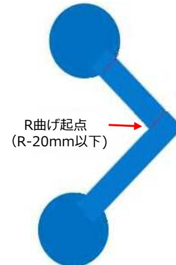
図3 試験片の初期変形状
