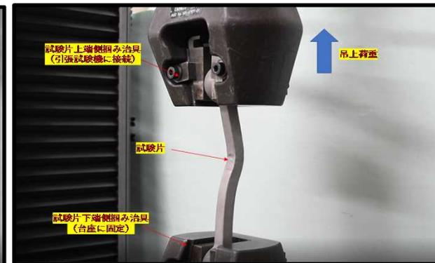
引張試験装置（破断試験）
