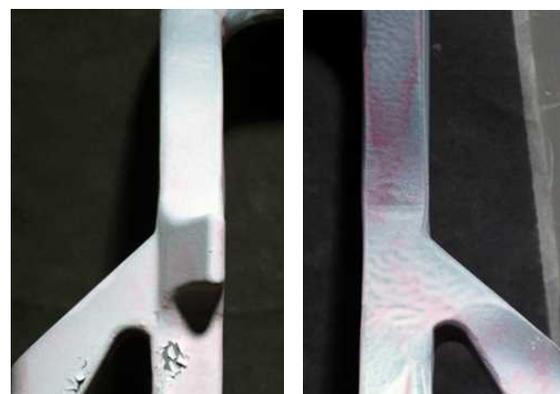
ハンドル引張試験後の浸透探傷試験結果
