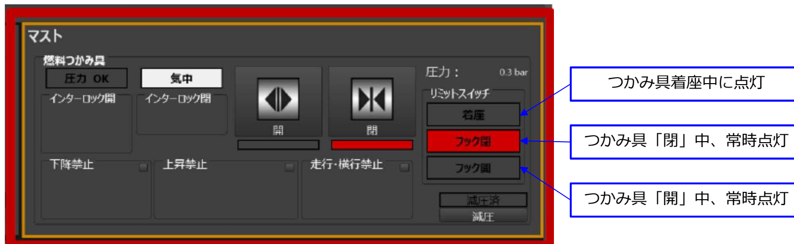
燃料取扱機操作卓 マスト操作画面（正常時）
