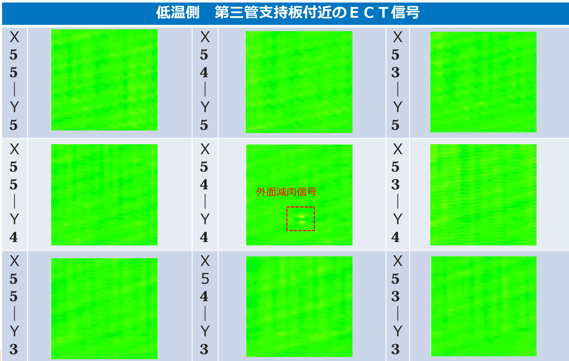
摩耗痕のある伝熱管と隣接した伝熱管の E C T 結果 (M I X : B - S G の例)
