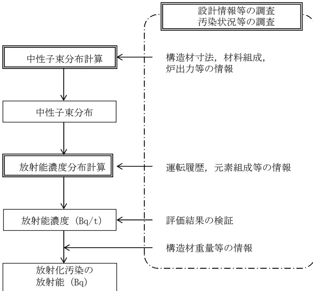
第1図 放射化汚染の評価フロー
