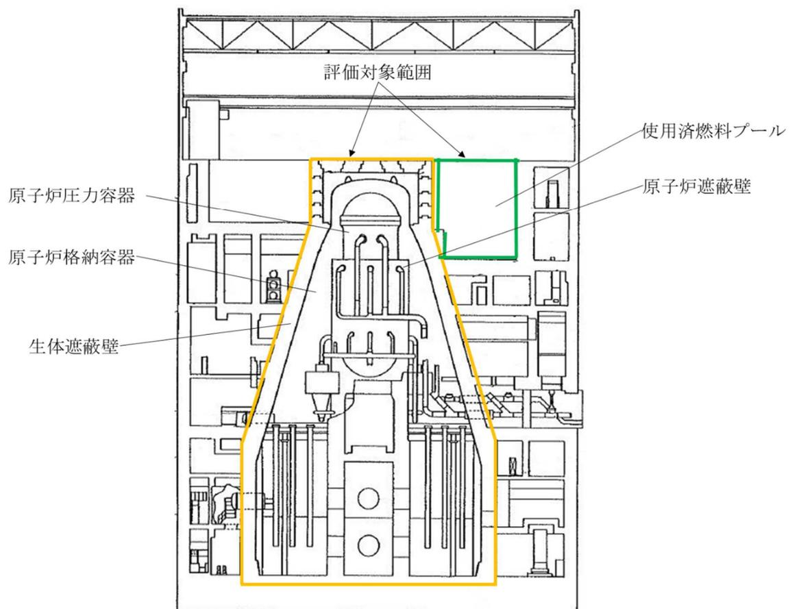
第2図 放射化汚染の対象範囲（1号炉）
