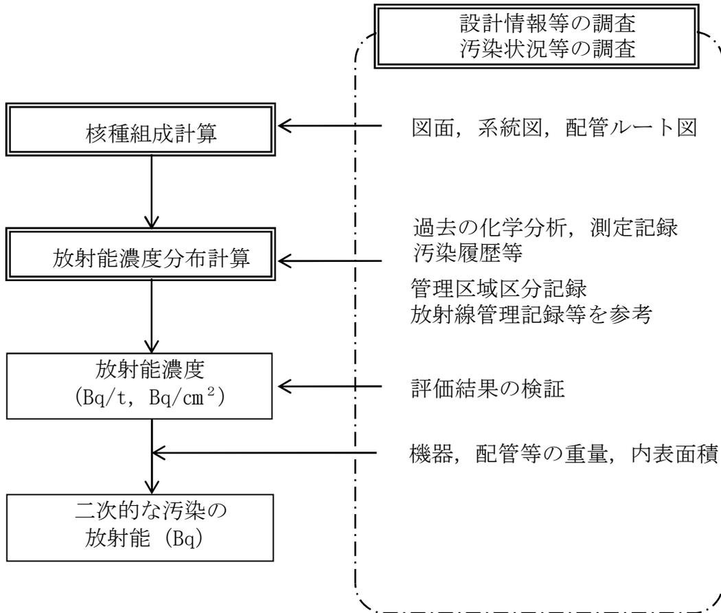
第3図 二次的な汚染の評価フロー
