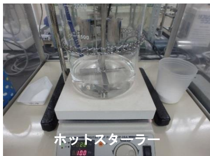
ホットスターラー 処理対象溶液の調整 (室温 or 50°C)
