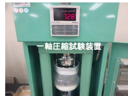
一軸圧縮試験装置 圧縮強度測定 (28日養生後)
