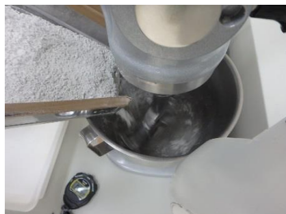
ミキサーによる混練 (セメント材の投入)
