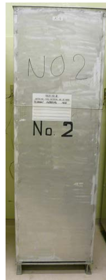
既存貯蔵設備 酸化ウラン燃料の例 63cm×63cm×200cm h
