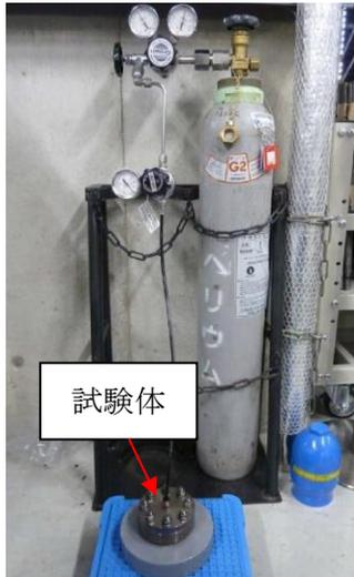
図5 He 気密確認試験状況
