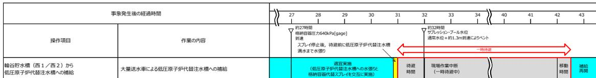
図 1 大量送水車による低圧原子炉代替注水槽への補給 タイムチャート
