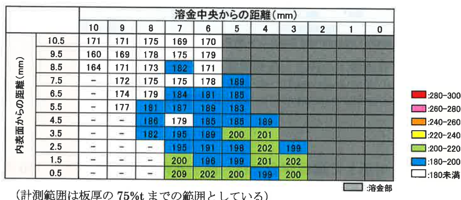
図－５ 4B 配管 TIG+SMAW 溶接 板厚内部硬さ測定結果
