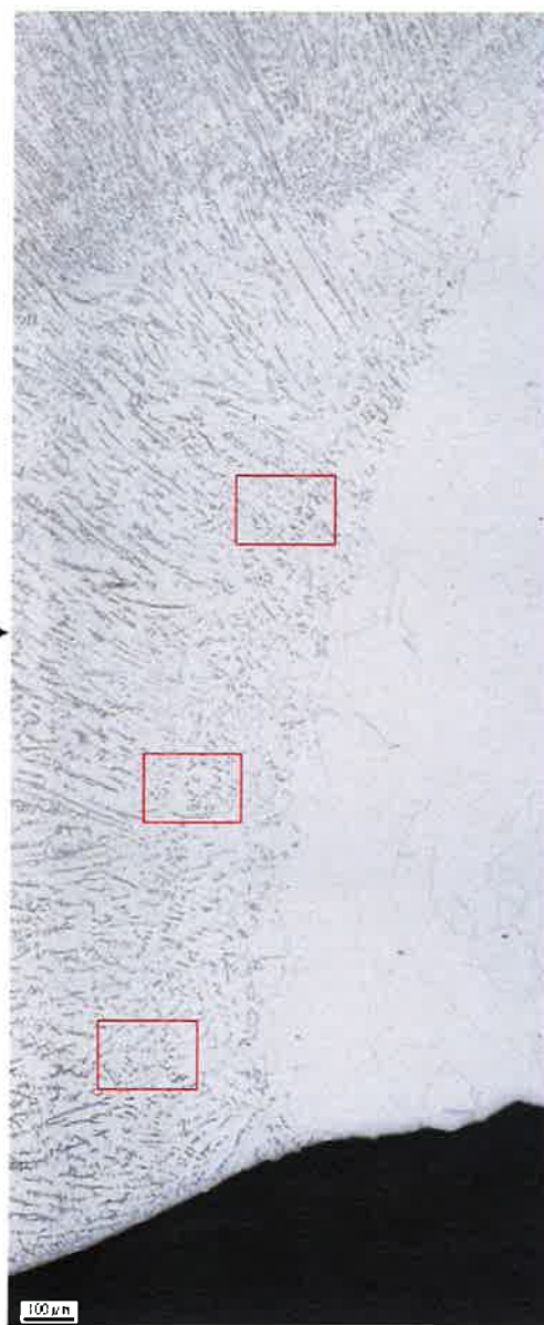
図-5 モックアップによる \delta フェライト確認結果
