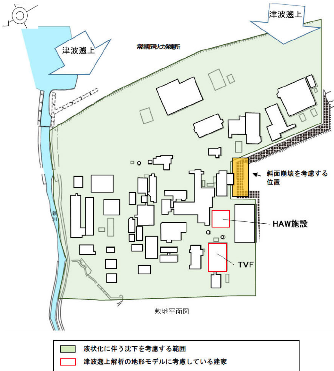
図 2 液状化に伴う沈下を考慮する範囲
