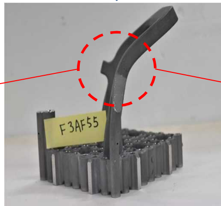
引張試験後（9 x 9 燃料（A型））
