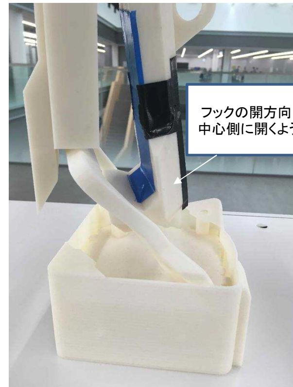
ハンドル変形燃料に対する掴み具センタリング(反CF側に変形している場合の例)
