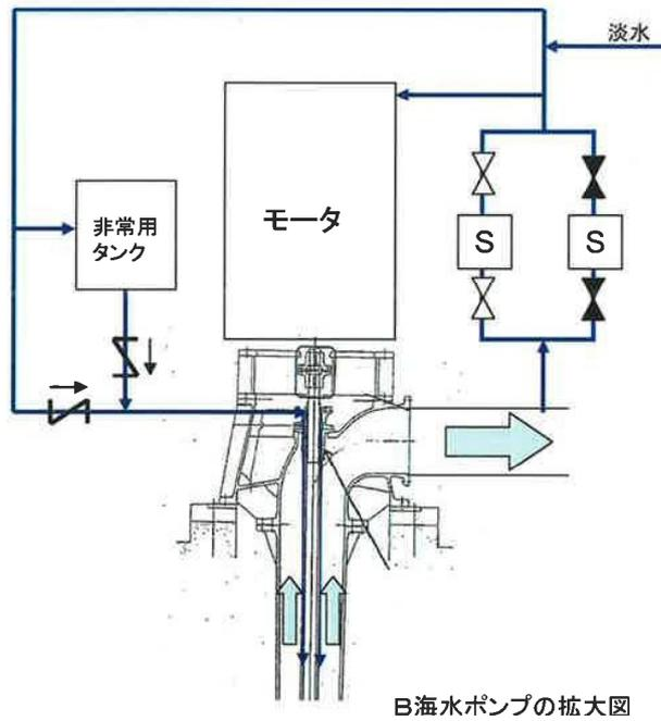
図 2 海水ポンプ軸受潤滑水系統概略図
