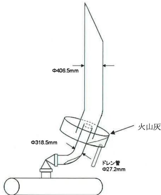
図1 主蒸気安全弁排気管の構造図
