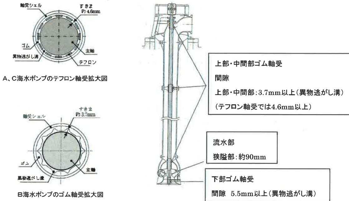
図 3 海水ポンプ軸受構造図
