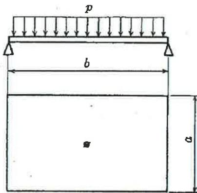
図 4 辺支持平板の評価モデル
