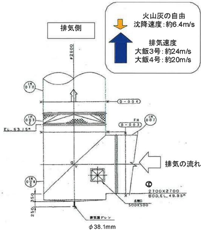
図1 排気筒曲がり部の構造（大飯3号炉）
