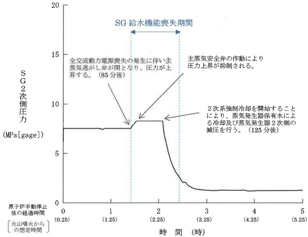
第1図 蒸気発生器2次側圧力
