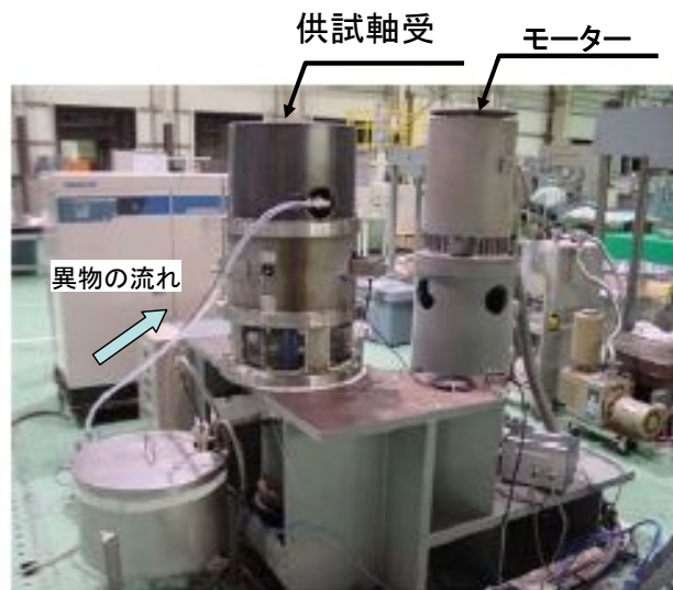
図-2 海水ポンプ軸受摩耗試験装置
