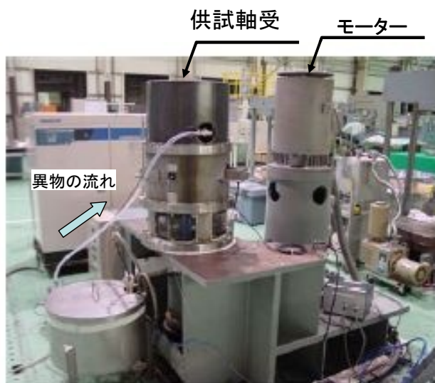
図-2 海水ポンプ軸受摩耗試験装置
