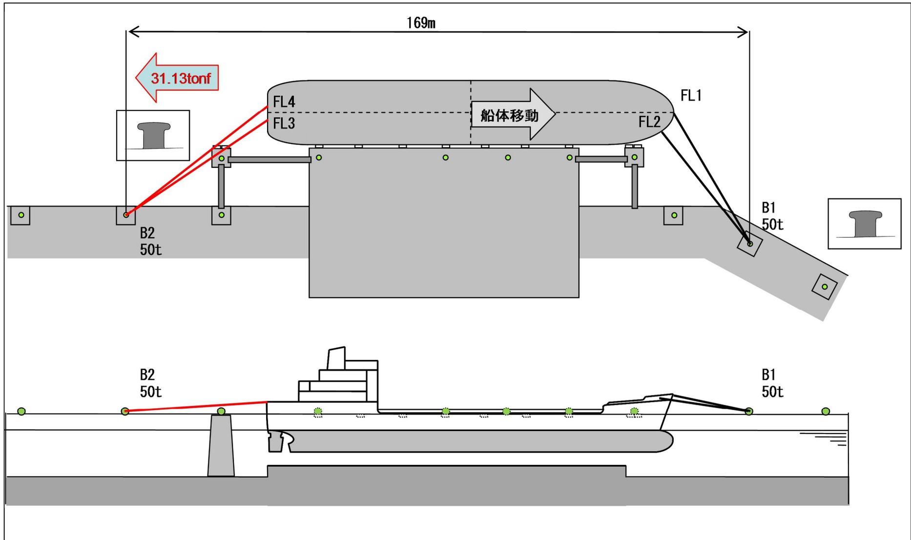
図-5 船首方向への移動に対する船尾方向係留力
