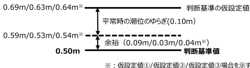
図-1-4-9 取水路防潮ゲートの閉止判断基準の概念図
