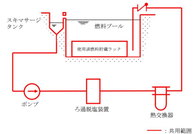
別紙図 2-2-3 燃料プール冷却系概要図
