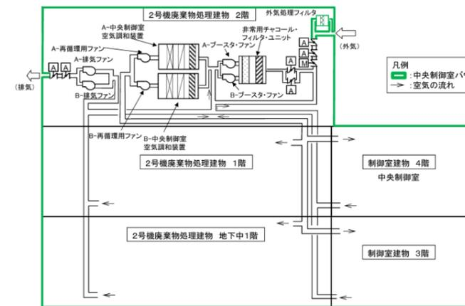
図 2-1 中央制御室換気系系統概要図
