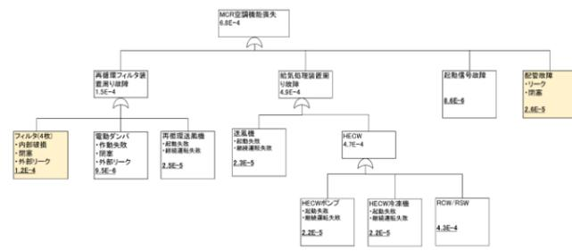
図2 概略フォールトツリー (MCR 空調)
