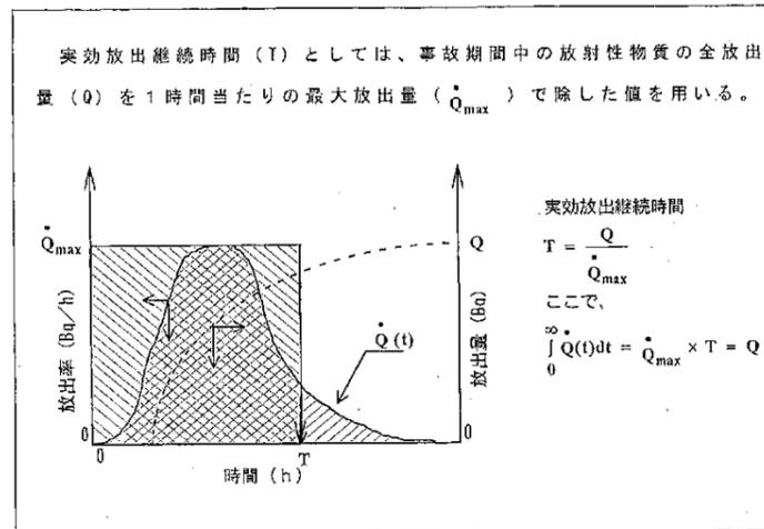
(3) 実効放出継続時間 (T) は、想定事故の種類によって放出率に変化があるので、放出モードを考慮して適切に定めなければならないが、事故期間中の放射性物質の全放出量を 1 時間当たりの最大放出量で除した値を用いることもひとつの方法である。
