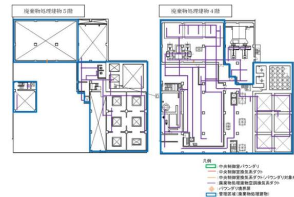
図 2-2 中央制御室換気系ダクト配置図
