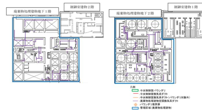
図 2-5 中央制御室換気系ダクト配置図
