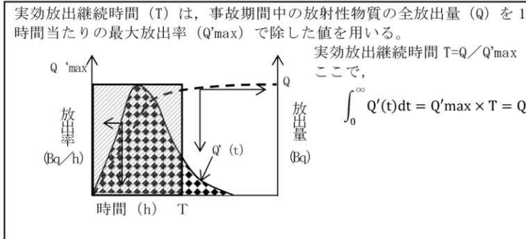
(3) 実効放出継続時間 (T) は、想定事故の種類によって放出率に変化があるので、放出モードを考慮して適切に定めなければならないが、事故期間中の放射性物質の全放出量を 1 時間当たりの最大放出量で除した値を用いることもひとつの方法である。
