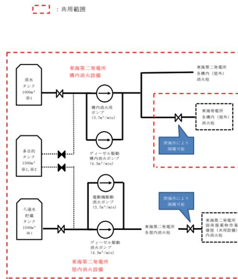
※1 原水タンク、ろ過水貯蔵タンク及び多目的タンクは給水処理系設備であるが、構内及び屋内消火設備給源であるため併せて記載。
