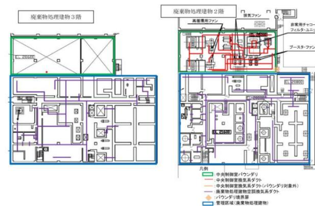
図 2-3 中央制御室換気系ダクト配置図
