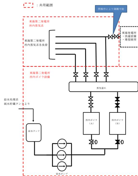
5. 補助ボイラ, 所内蒸気系
