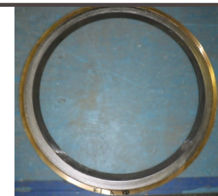
タービン動主給水 ブースタポンプ入口フランジ
