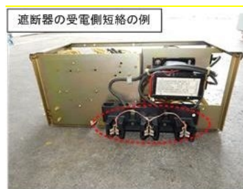
図 4.5.3 遮断器の短絡箇所 (C/C試験時)
