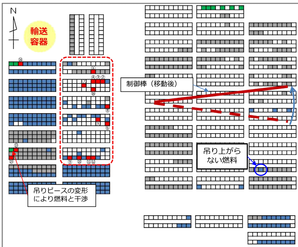
3号機使用済燃料プール (39回目までの取り出し状況を反映)
