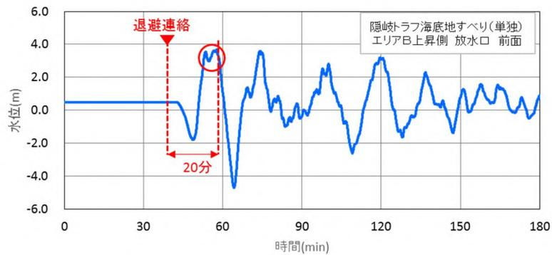
参考図 1-1 基準津波 3 の時刻歴波形
