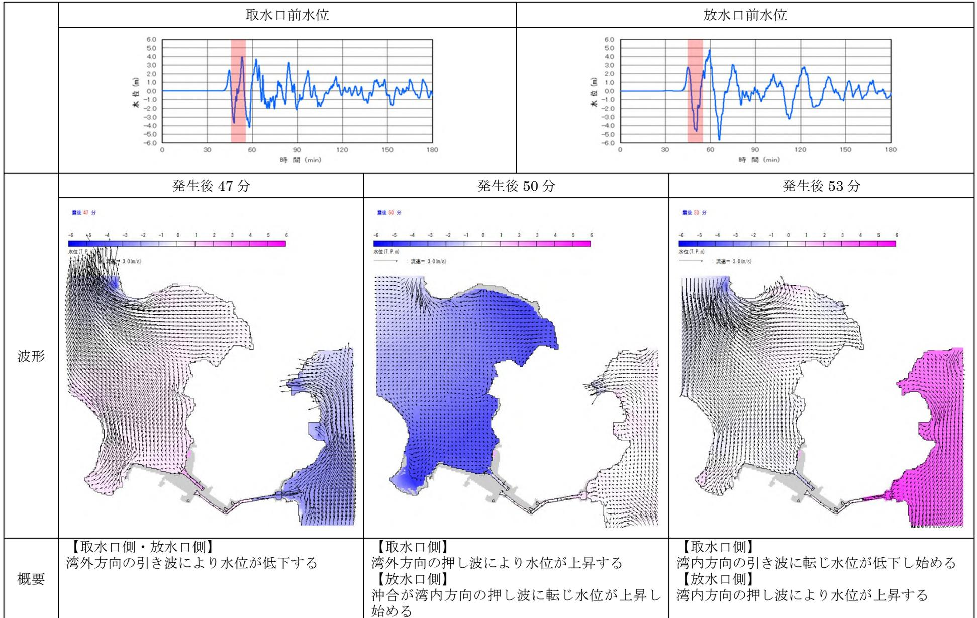
図2 (2/3) 基準津波1の流向・流速の概要
