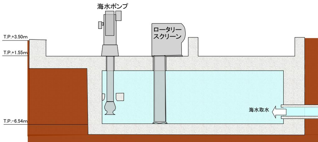
図-2-5-44 除塵装置概略図
