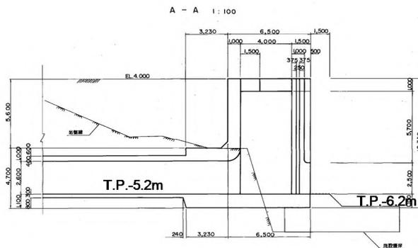
図-2-5-39 非常用開水路呑み口及び海水取水トンネル呑み口
