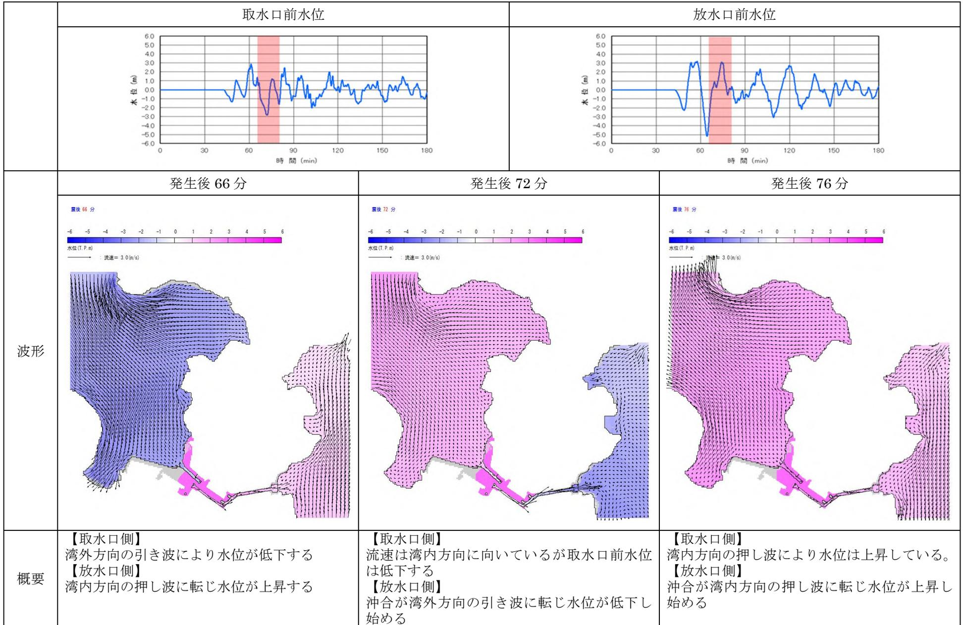
図 3 (3/3) 基準津波 3 の流向・流速の概要
