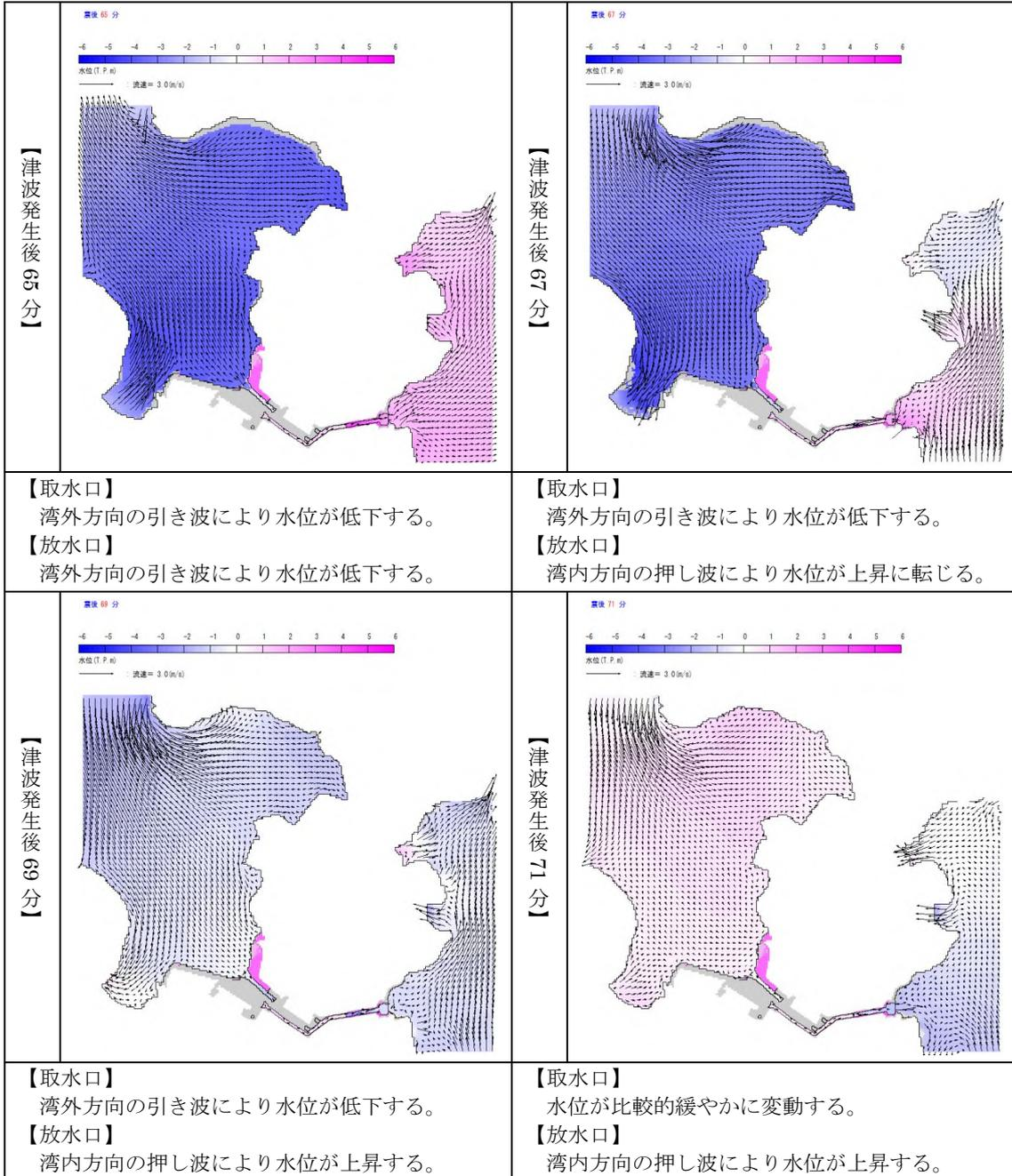
図 5 (4/6) 基準津波 1 の流速及び流向
