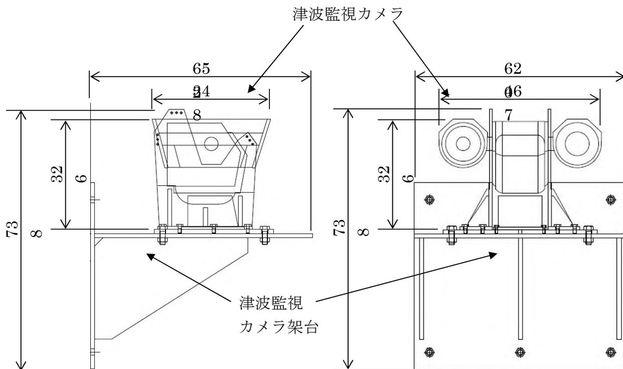
図 3-3-3 津波監視カメラ外形図
