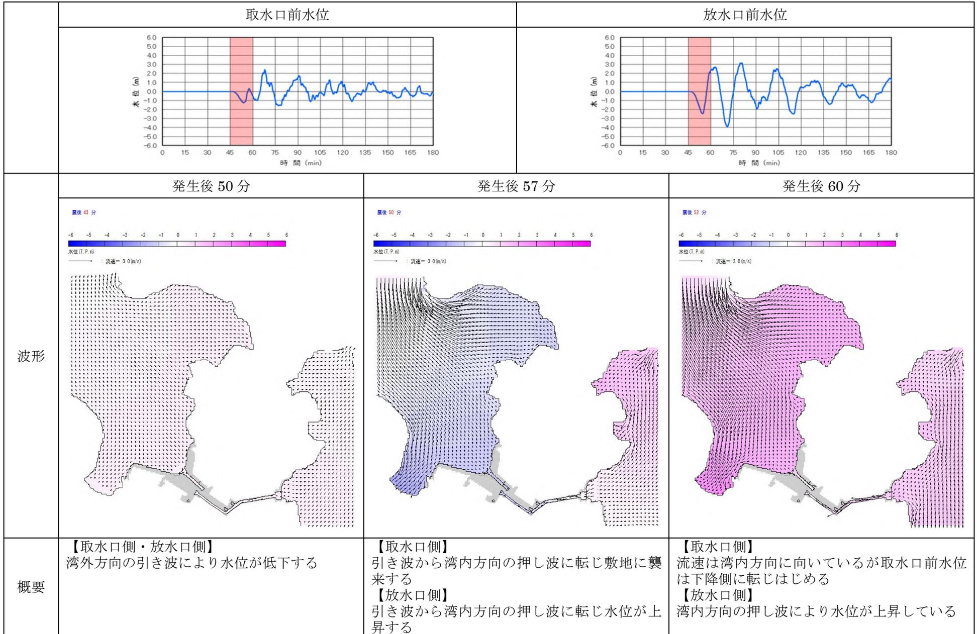
図 4 (1/2) 基準津波 4 の流向・流速の概要
