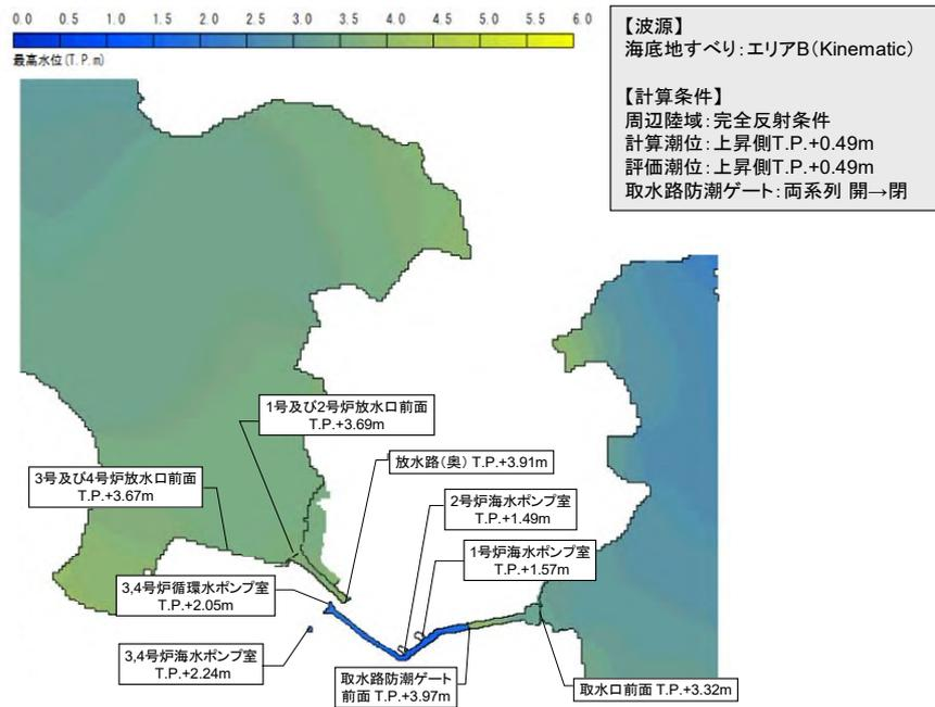
図3 最大水位上昇量分布図 (基準津波3)
