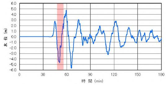
基準津波 1 (1号及び2号炉放水口前面)
