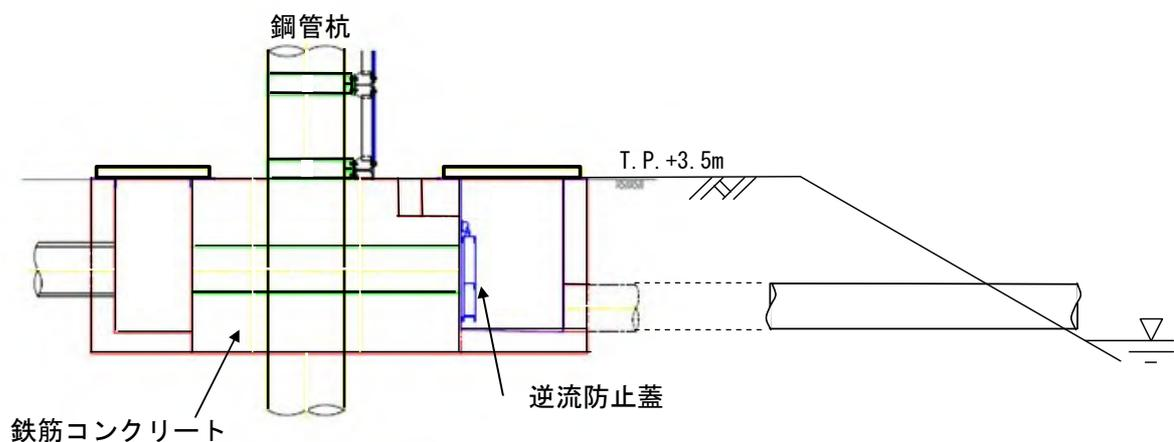
図-3-1-15 逆流防止設備断面図 (例)
