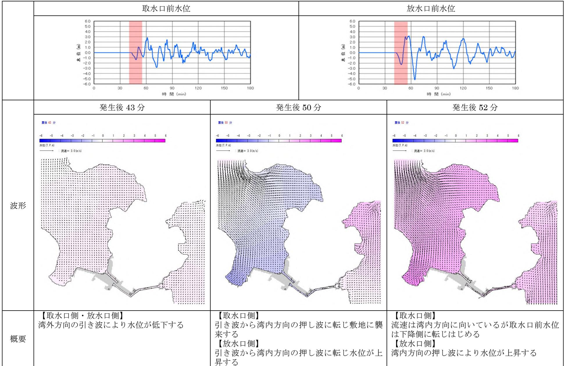
図3 (1/3) 基準津波3の流向・流速の概要
