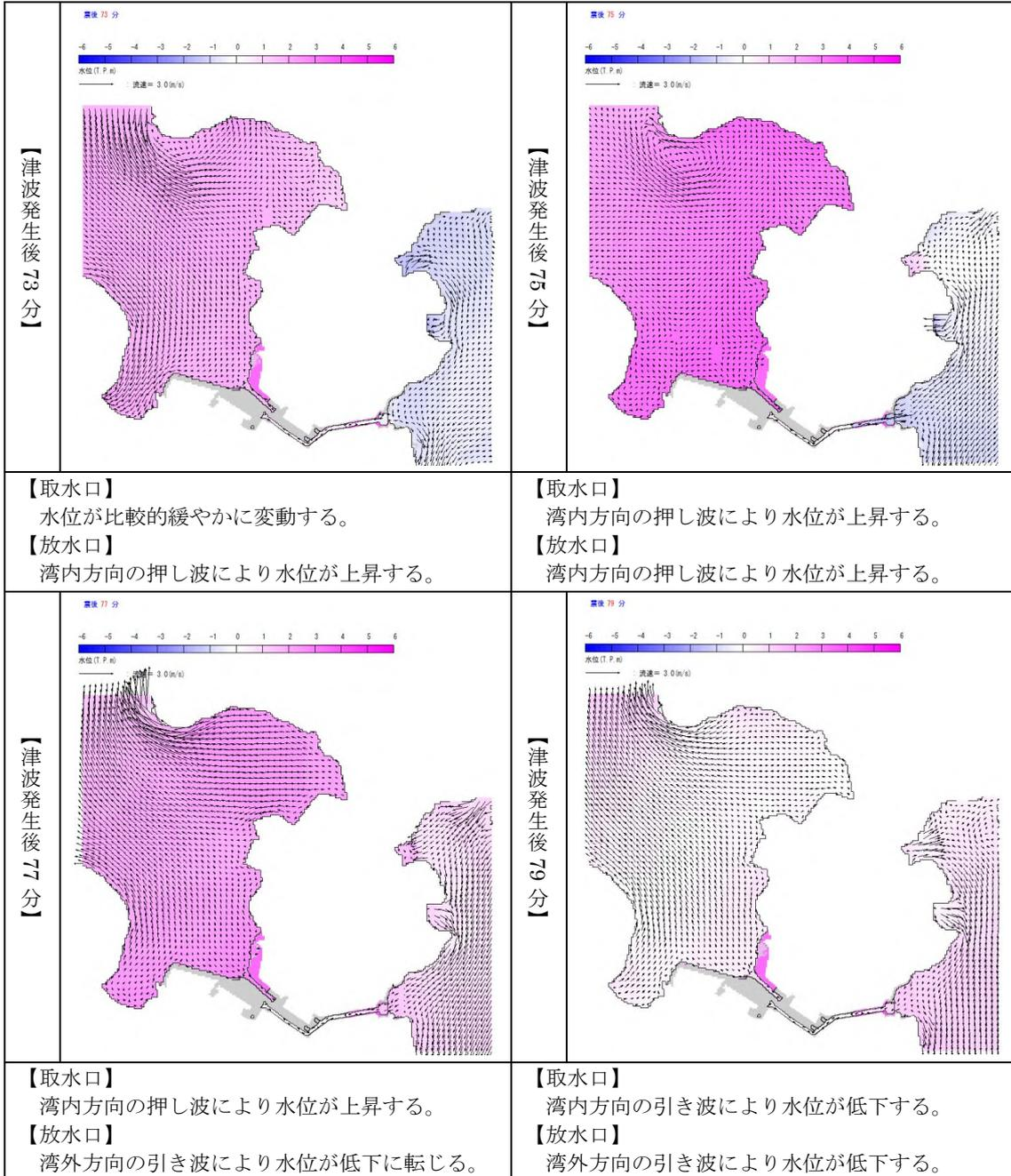
図 5 (5/6) 基準津波 1 の流速及び流向
