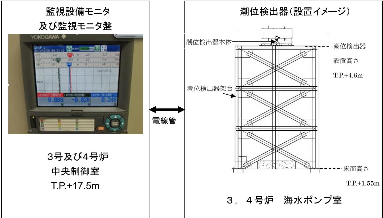
図 3-3-5 (2/2) 潮位計 (監視用) 設備構成イメージ
