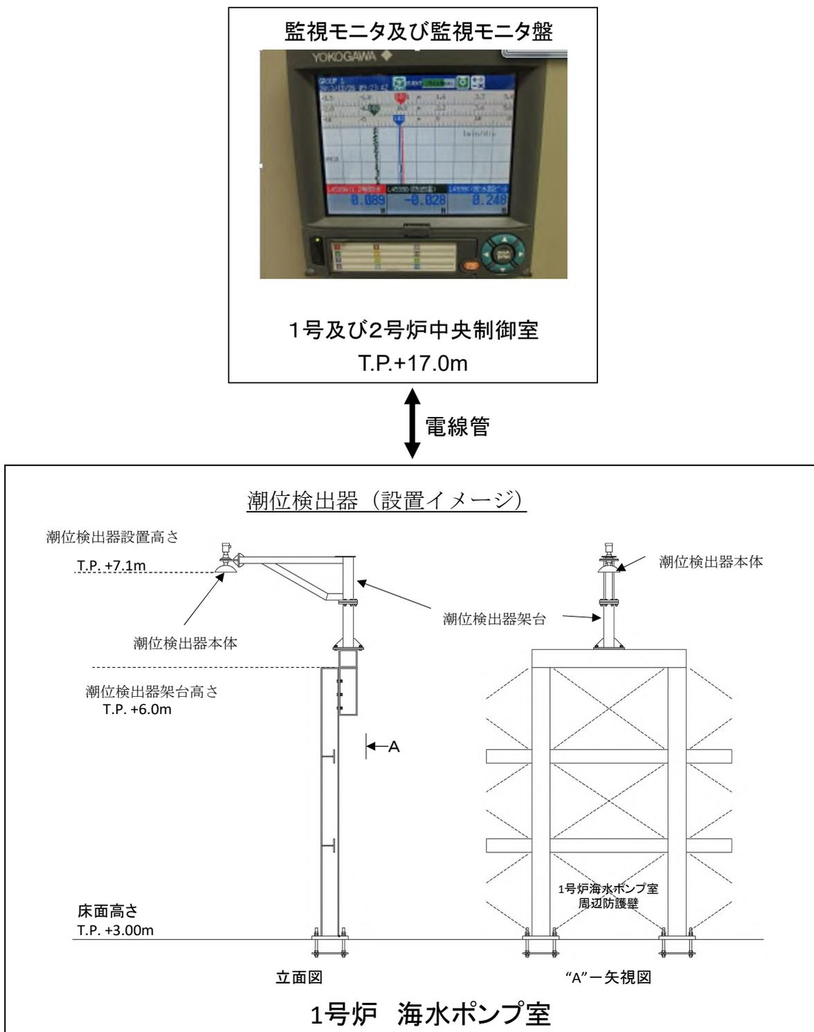
図 3-3-5(1/2) 潮位計（監視用）設備構成イメージ
