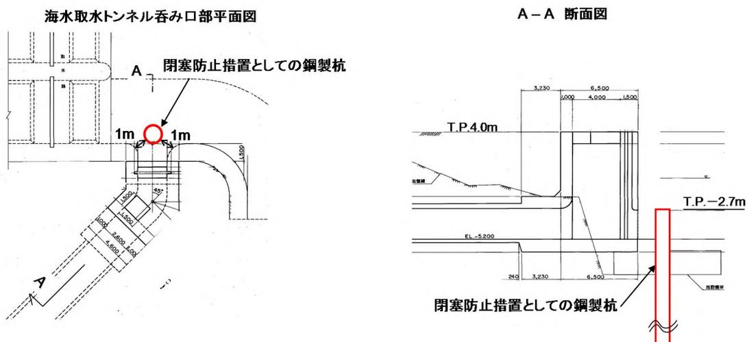
図-2-5-41 漂流物による閉塞防止措置
