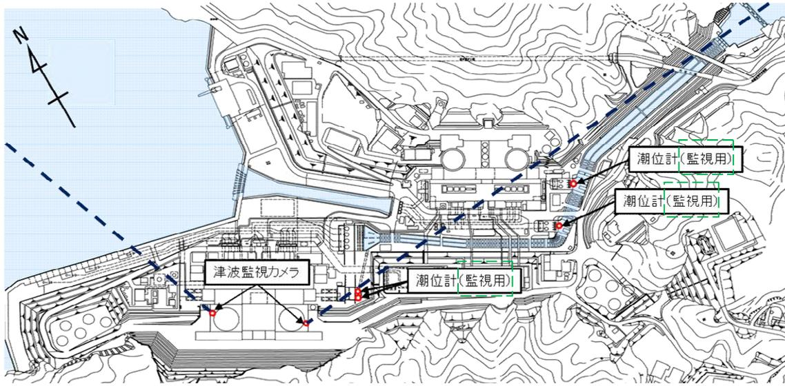
図 2-6-1 津波監視関係設備配置図
