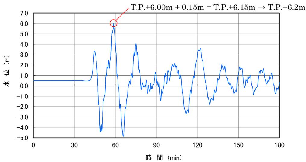
3号及び4号炉放水口前面 (若狭海丘列付近断層と隠岐トラフ海底地すべり (エリアB) の組合せ)
