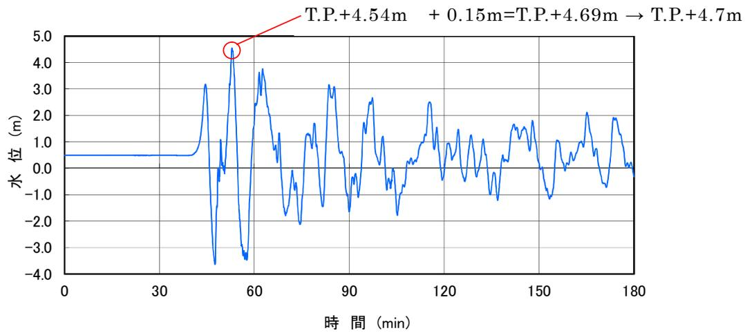
取水路防潮ゲート前面（若狭海丘列付近断層と隠岐トラフ海底地すべり（エリアB）の組合せ）
