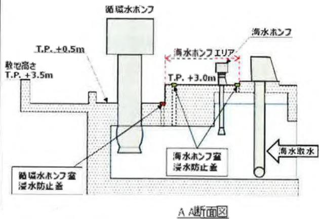
第 1.4.5 図(2) 2号炉海水ポンプ室周辺エリア浸水防止設備の概要
