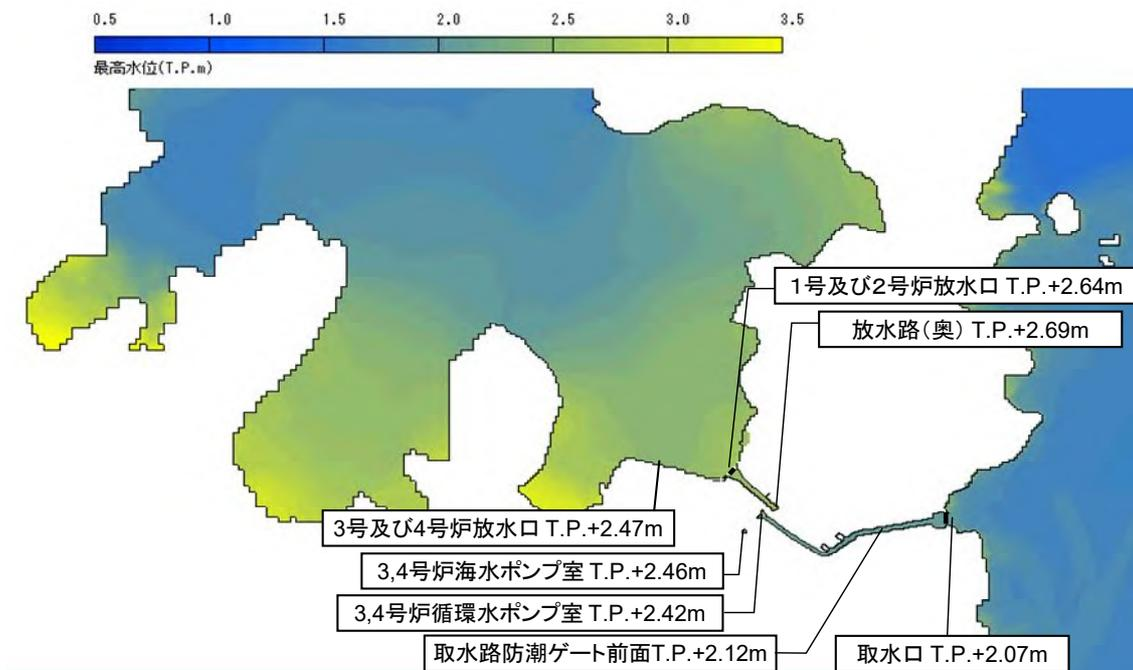
第 1.5.2 図(2) 基準津波 2 による最高水位分布
