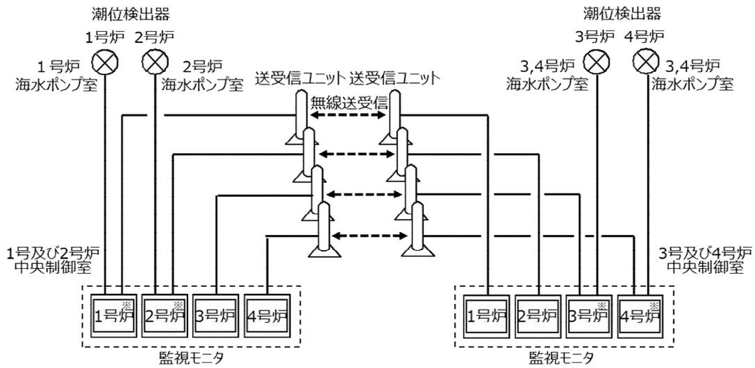
※電源箱及び演算装置は監視モニタの盤内機器であり、監視モニタの一部である。
