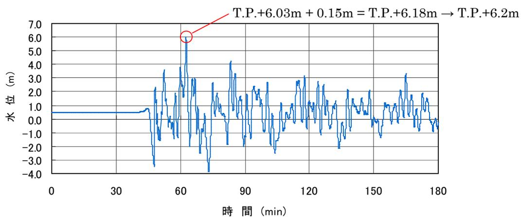
1号炉海水ポンプ室前面（FO-A～FO-B～熊川断層と陸上地すべり No.14の組合せ）
