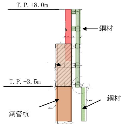
鉄筋コンクリート壁部
