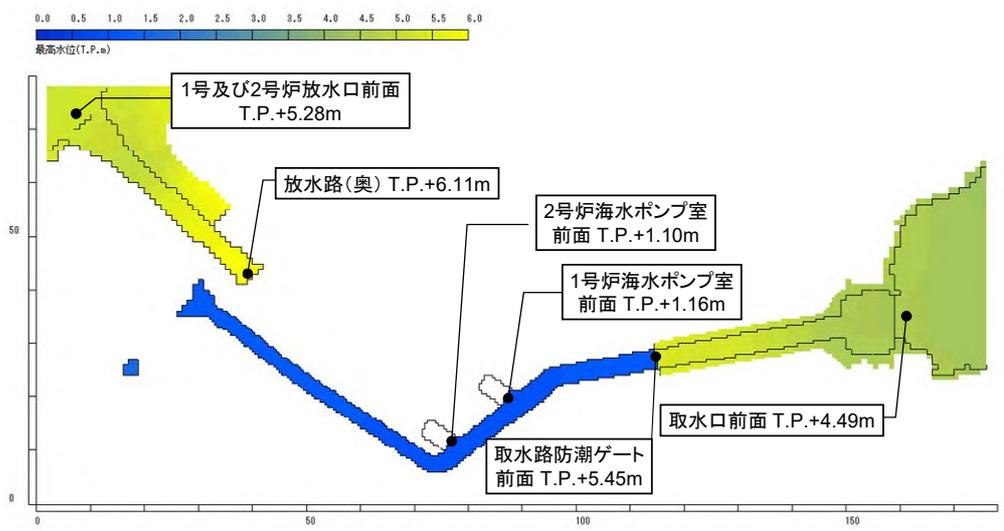
第 1.4.2 図(1) 基準津波 1 による最高水位分布
