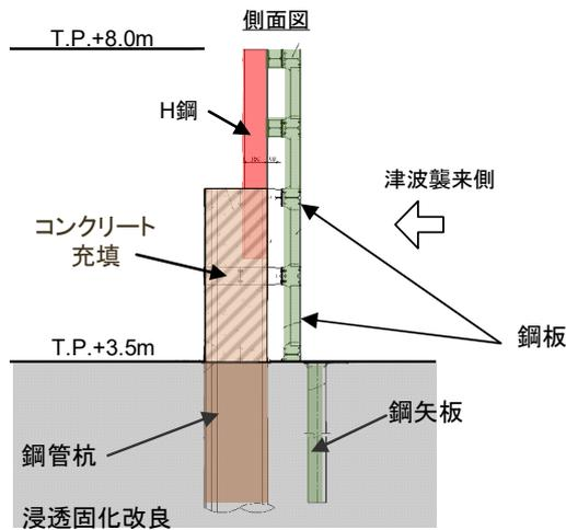
鉄筋コンクリート壁部
