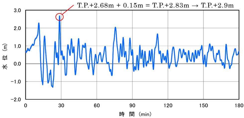
1号及び2号炉放水口前面 (若狭海丘列付近断層と隠岐トラフ海底地すべり (エリアB) の組合せ)
