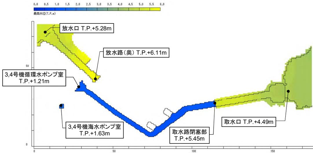
第 1.5.2 図(1) 基準津波 1 による最高水位分布
