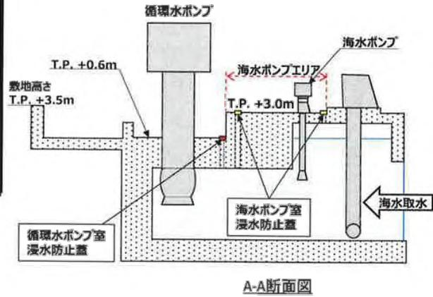
第 1.4.5 図(1) 1号炉海水ポンプ室周辺エリア浸水防止設備の概要
