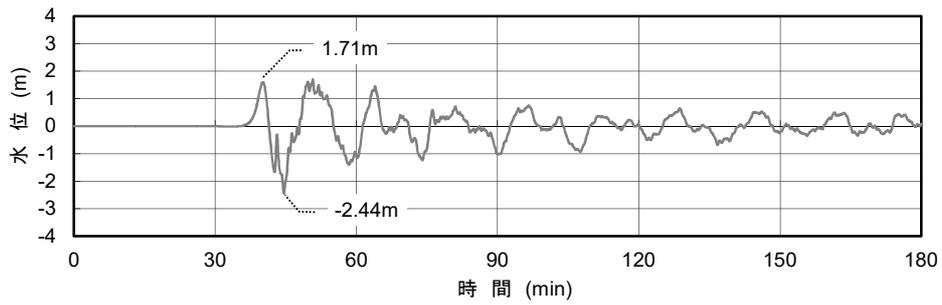
基準津波 1 若狭海丘列付近断層と隠岐トラフ海底地すべり(エリア B)を波源とする時刻歴波形
