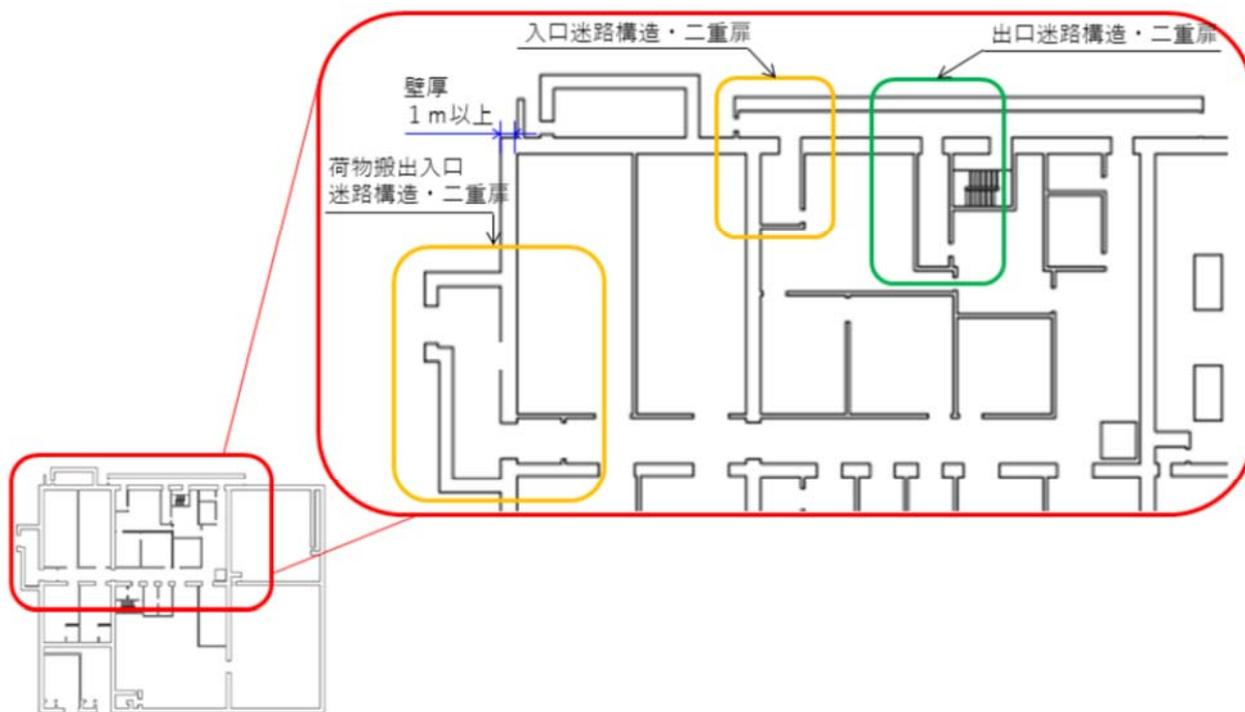
第2.1.3-1図 緊急時対策建屋 遮蔽設計
