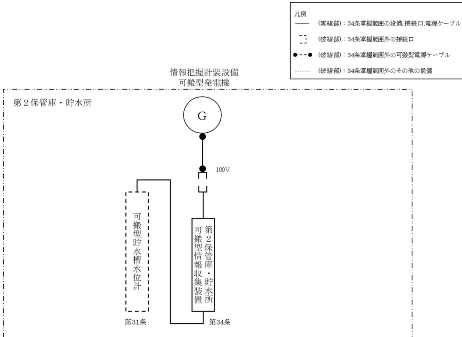
第 34. 5 図 情報把握設備 電源供給系統図 ( 5 / 5 )
