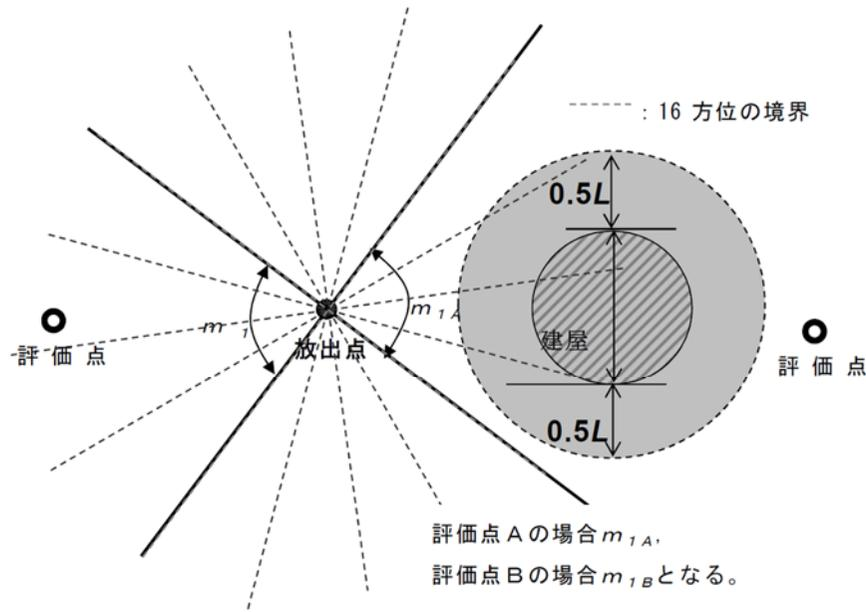
注：Lは、風向に垂直な建屋の投影面の高さ又は投影面の幅のうちの小さい方
