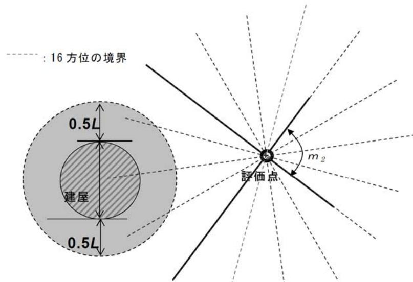
注:Lは、風向に垂直な建屋の投影面の高さ又は投影面の幅のうちの小さい方
