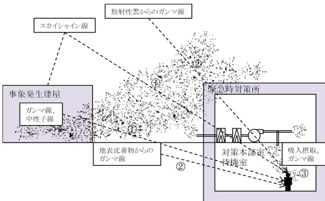
第 1 - 3 図 緊急時対策所の対策要員の被ばく経路イメージ図
