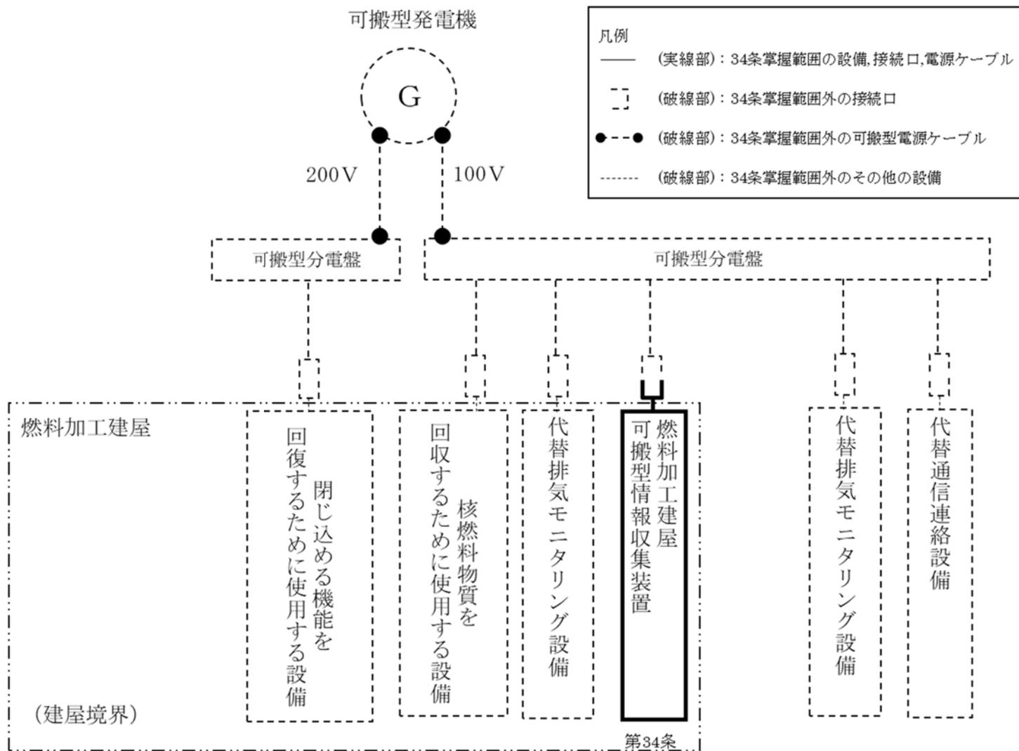
第 34. 5 図 情報把握設備 電源供給系統図 ( 1 / 5 )
