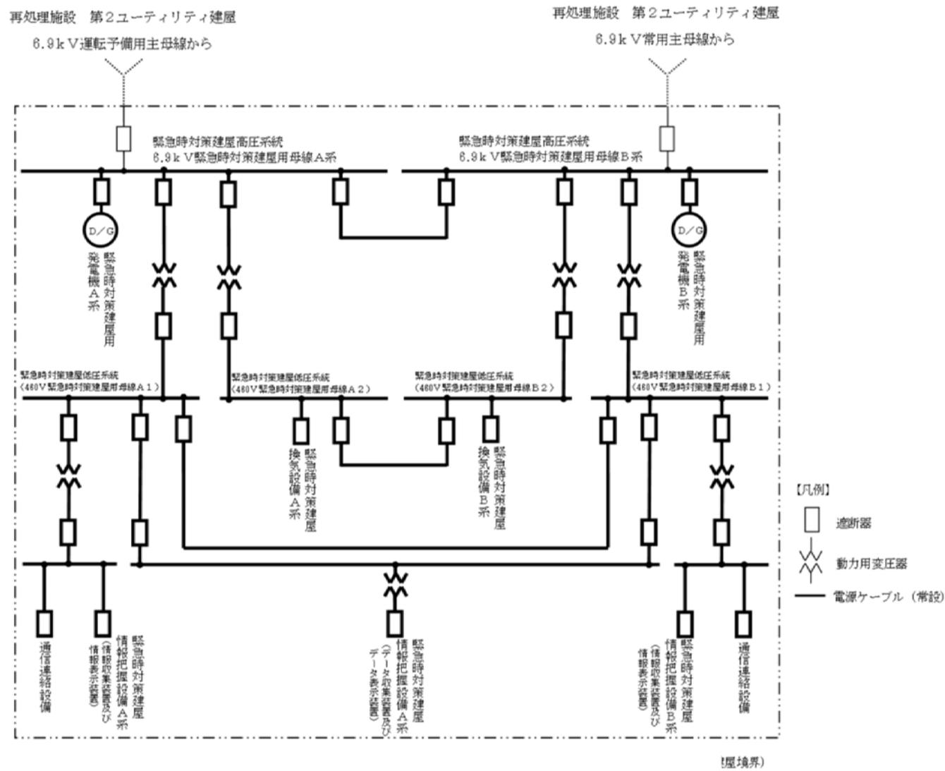
第 2.1.2-1 図 緊急時対策建屋 単線結線図
