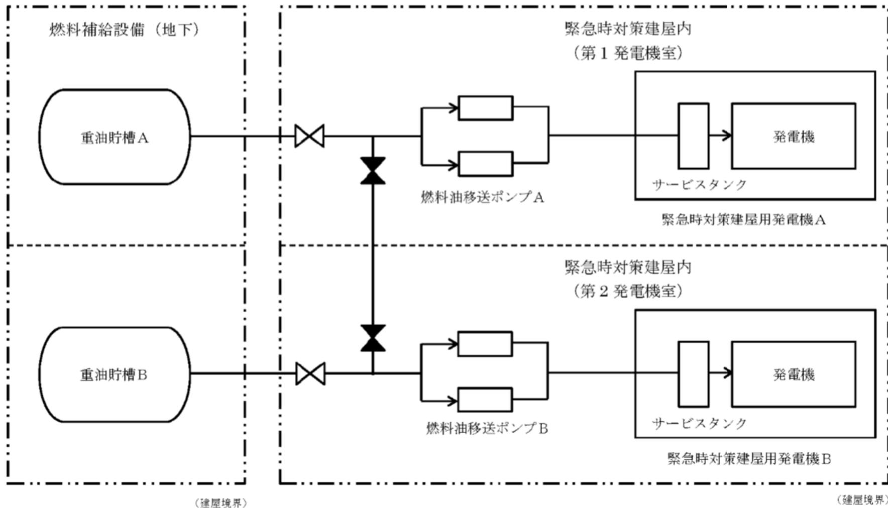
第 34.11 図 燃料補給設備 系統概要図
