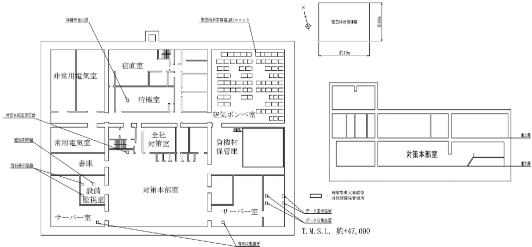
第 1. 1. 1 - 1 図 緊急時対策建屋内の各階配置図 (地下 1 階)
