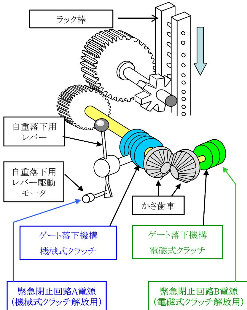
通常時:機械式クラッチ及び電磁式クラッチが連結されており、ゲート開状態が維持されている。
