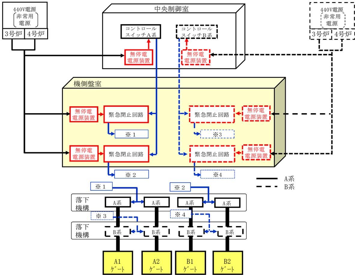
第 10.6.1.1.2 図 取水路防潮ゲート電源構成概念図
