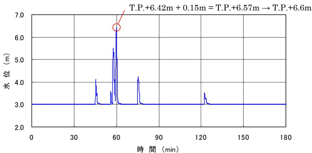
1号炉海水ポンプ室前面（水位下降側）（FO-A～FO-B～熊川断層と陸上地すべり
