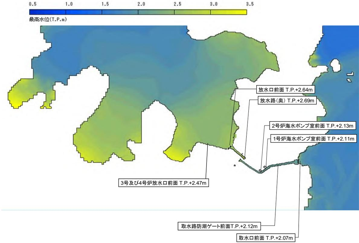
第 1.4.2 図(2) 基準津波 2 による最高水位分布
