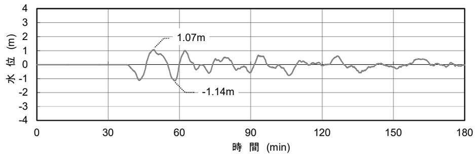
基準津波 3 隠岐トラフ海底地すべり(エリア B)を波源とする時刻歴波形
