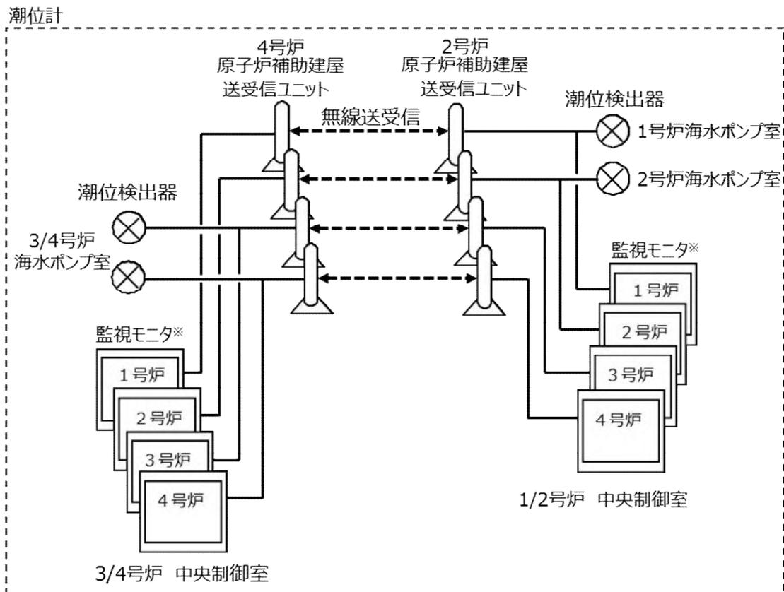
※電源箱及び演算装置は監視モニタの盤内機器であり、監視モニタの一部である。
