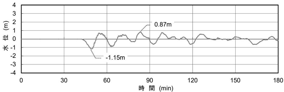
基準津波 4 隠岐トラフ海底地すべり(エリア C)を波源とする時刻歴波形※
