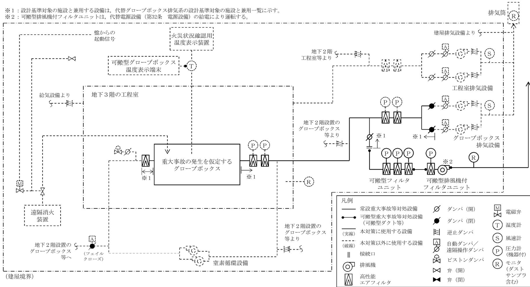
第 29. 5 図 代替グローブボックス排気系の系統概要図 (その 1)
