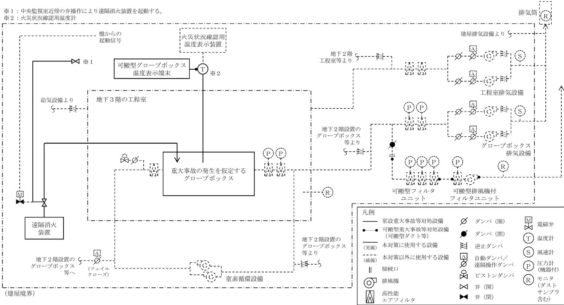
第 29. 1 図 代替消火設備及び代替火災感知設備の系統概要図 (外的事象の対処時)
