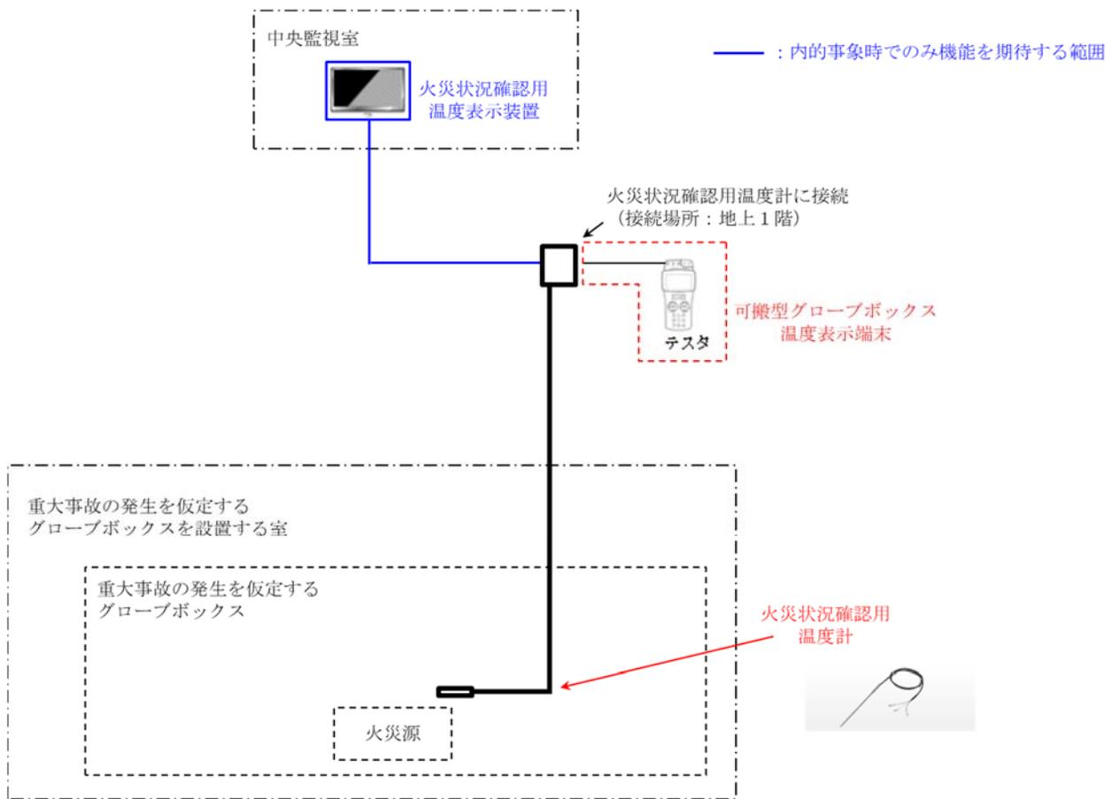
第 2-9.1 図 火災源の温度計測の概念図
