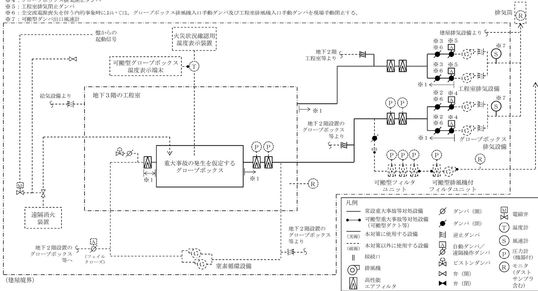
第 29. 4 図 放出防止設備の系統概要図 (内的事象の対処時) (その 1)
