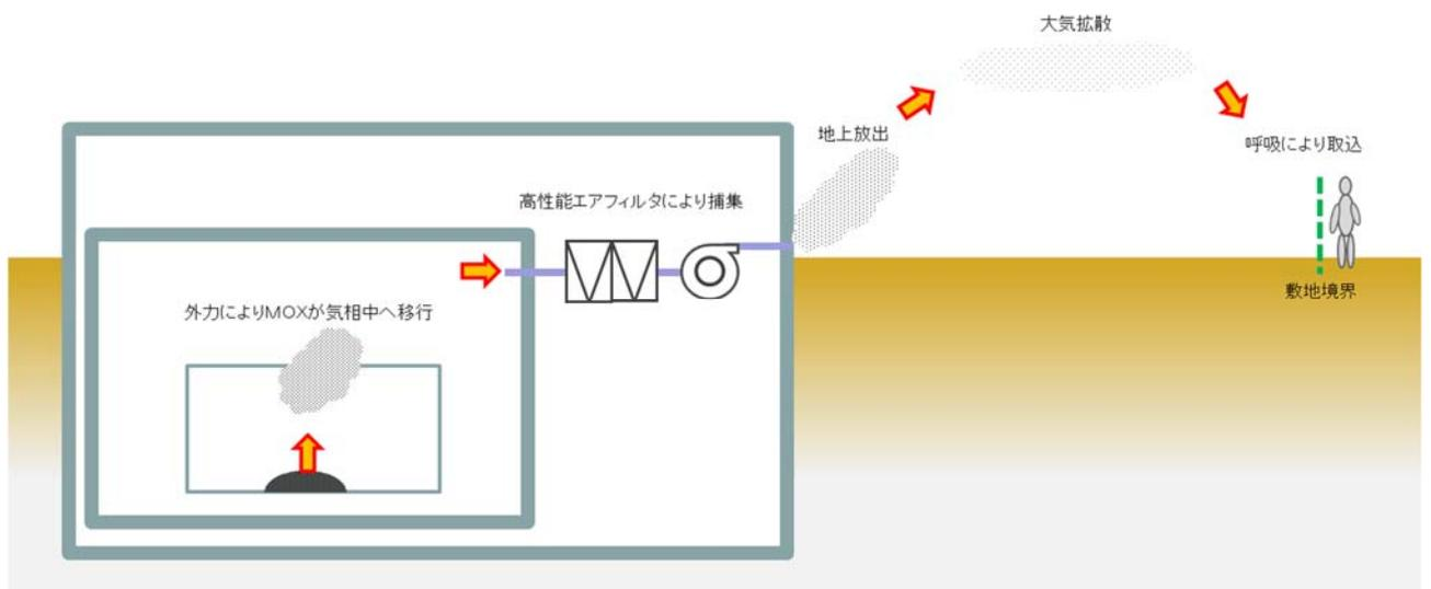
第1. 10-1 図 評価モデルのイメージ
