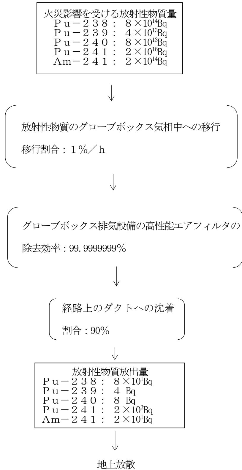
第3図 回収粉末処理・混合装置グローブボックスにおける閉じ込め機能の不全
