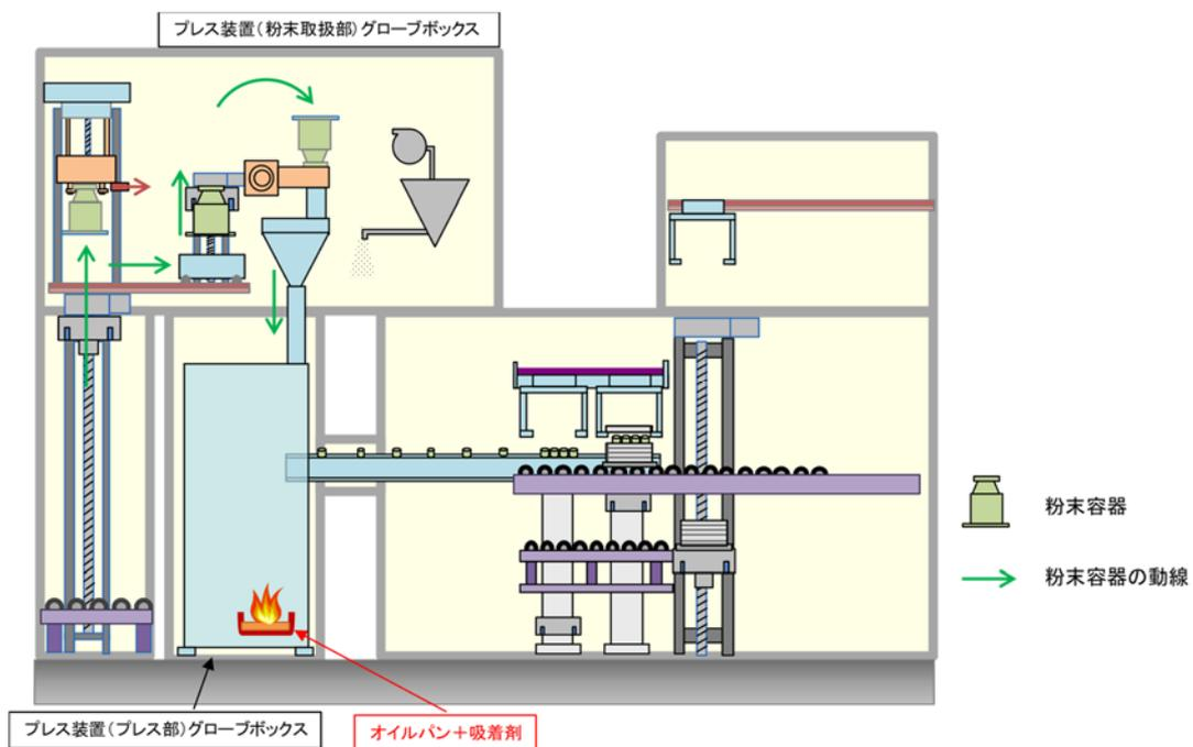
第6図 プレス装置グローブボックスにおける核燃料物質の取扱い及び火災源の位置のイメージ図
