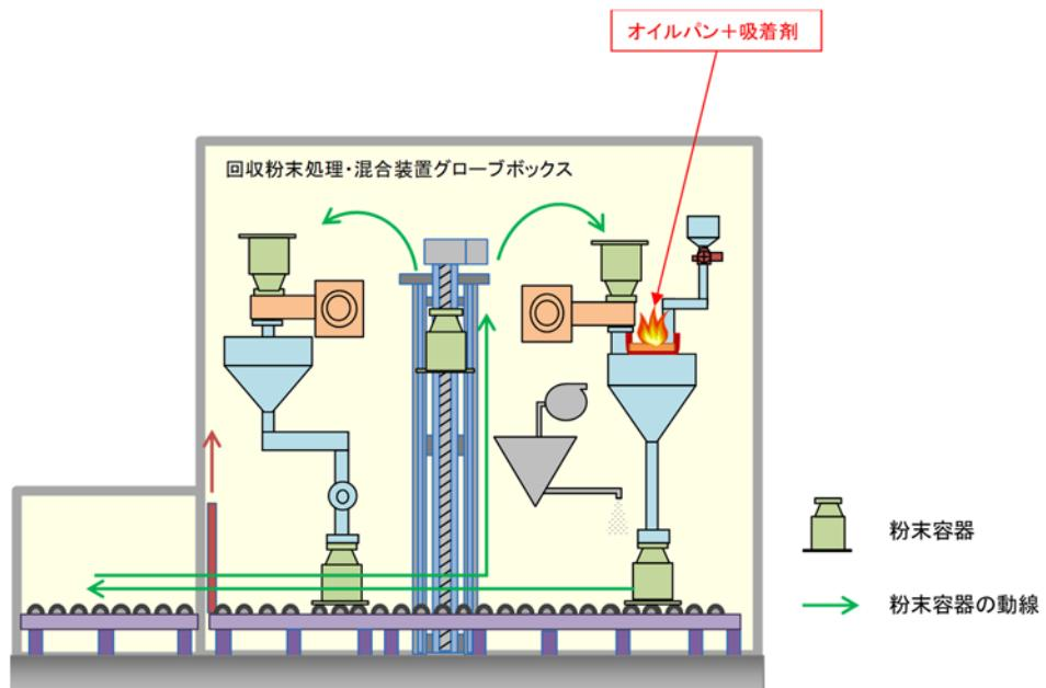
第4図 回収粉末処理・混合装置グローブボックスにおける核燃料物質の取扱い及び火災源の位置のイメージ図
