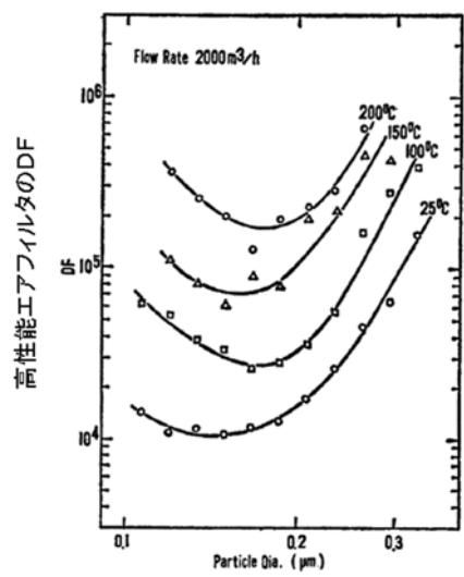
第1.8-3図 高性能エアフィルタの温度と捕集効率の
