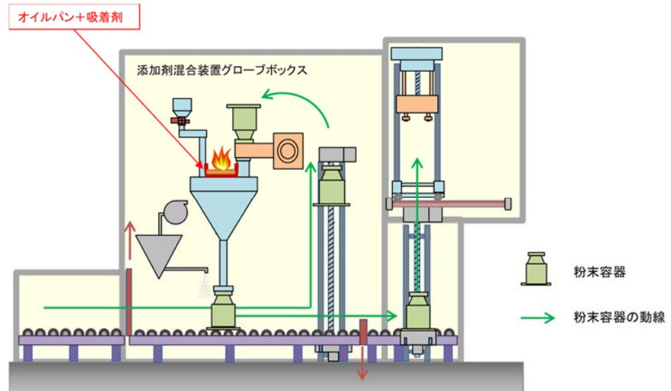
第5図 添加剤混合装置グローブボックスにおける核燃料物質の取扱い及び火災源の位置のイメージ図
