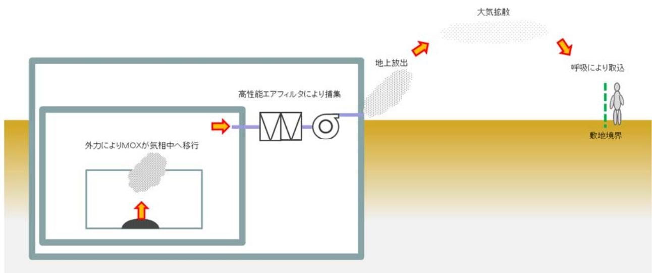
第1. 10-1図 評価モデルのイメージ
