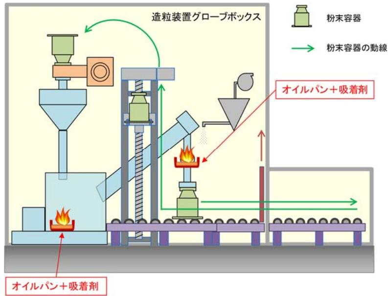
第3図 造粒装置グローブボックスにおける核燃料物質の取扱い及び火災源の位置のイメージ図
