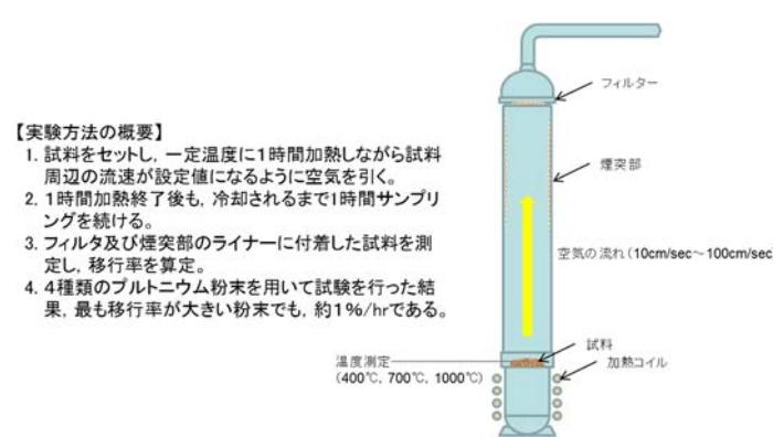
第1.7.1-1図 文献による実験の概要図
