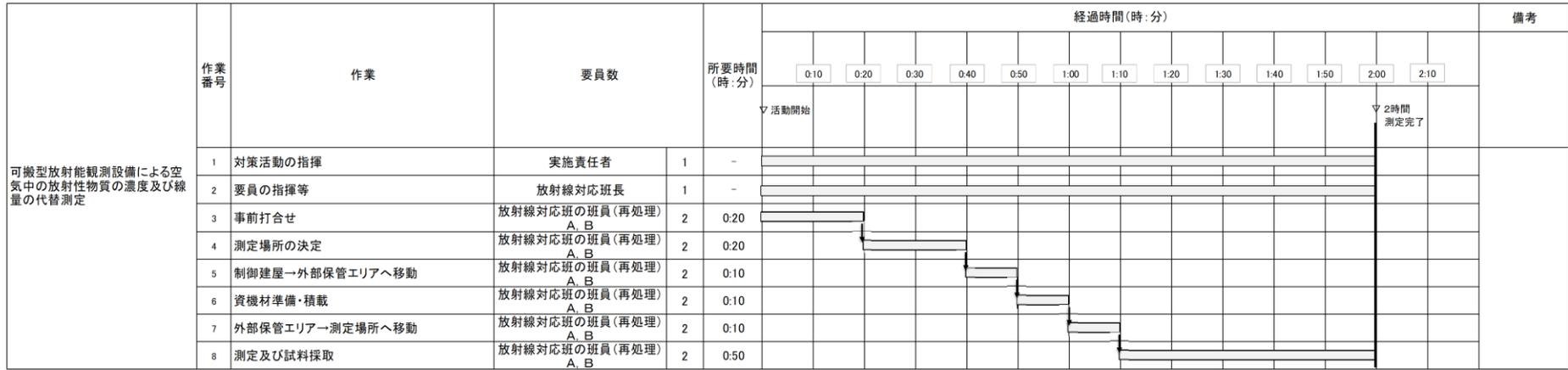
第2. 1. 8-16 図 可搬型放射能観測設備による空気中の放射性物質の濃度及び線量の代替測定のタイムチャート
