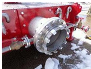
可搬型放水砲後部 可搬型建屋外ホース接続箇所 （300A）
