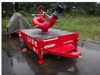
可搬型放水砲
