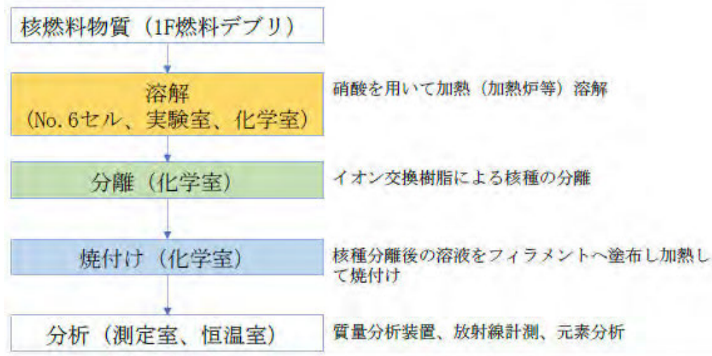
図-2 1F燃料デブリの溶解、分離、焼付けに関するフロー
