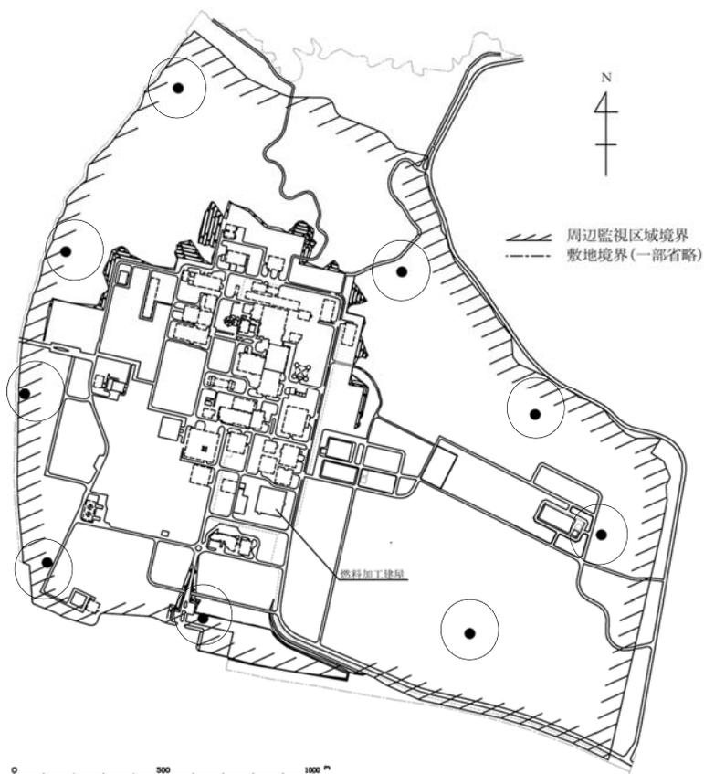
○ 可搬型環境モニタリング設備の設置場所の例
