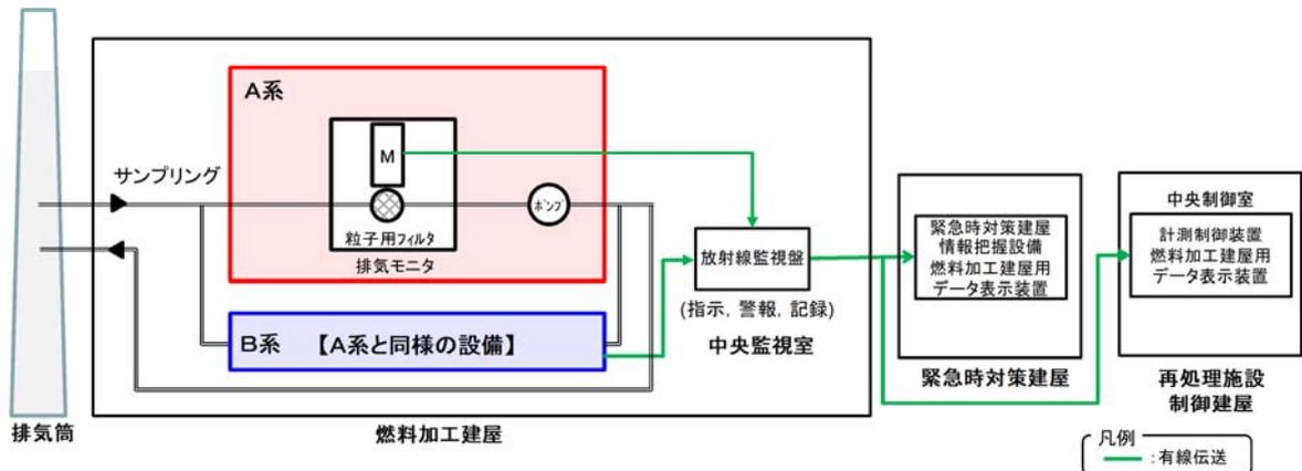
第1図 排気モニタの系統概要図
