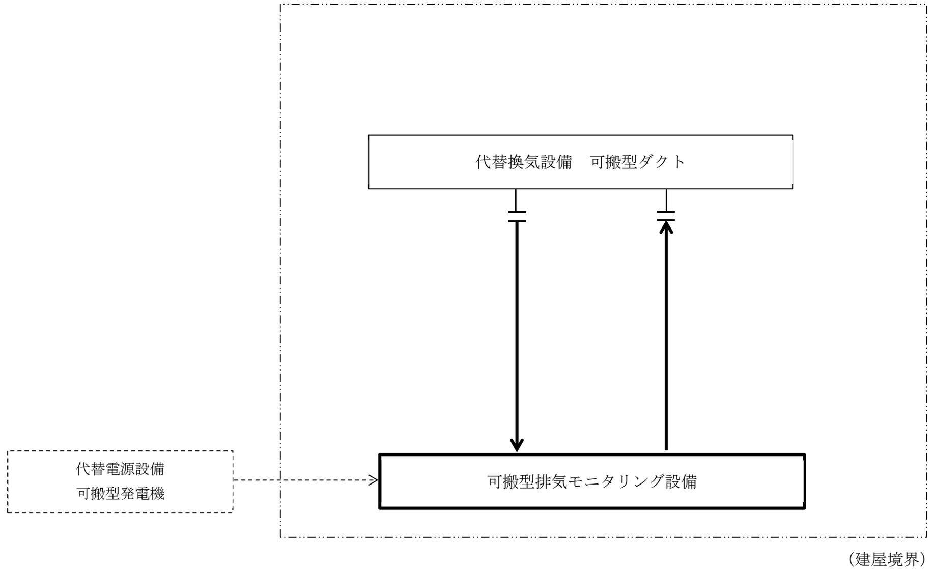
第 33. 3 図 代替モニタリング設備（可搬型排気モニタリング設備）の系統概要図
