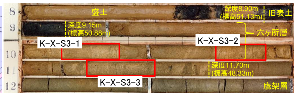
K-X孔コア写真(高位段丘堆積層は分布しない)
