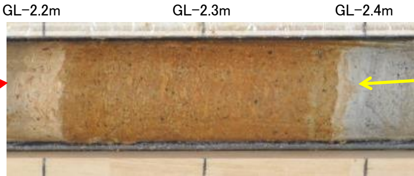
※N7-4孔の近隣 (1m北) でボーリング調査を新たに実施 (敷地造成により甲地軽石の出現深度が異なる)
