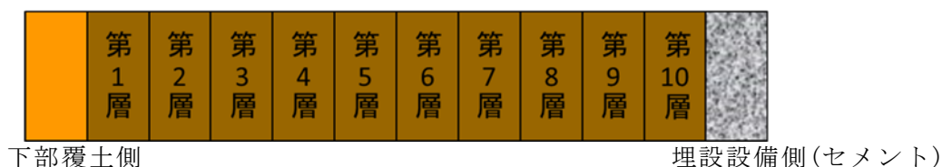
第 14 図 難透水性覆土の層の定義
