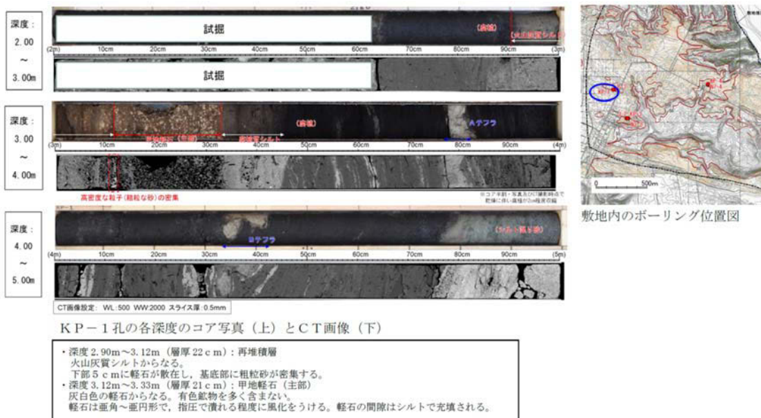
第 14 図 再処理施設敷地で確認された甲地軽石の堆積状況 *1
