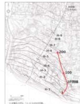
反射法地層探査測線位置図
