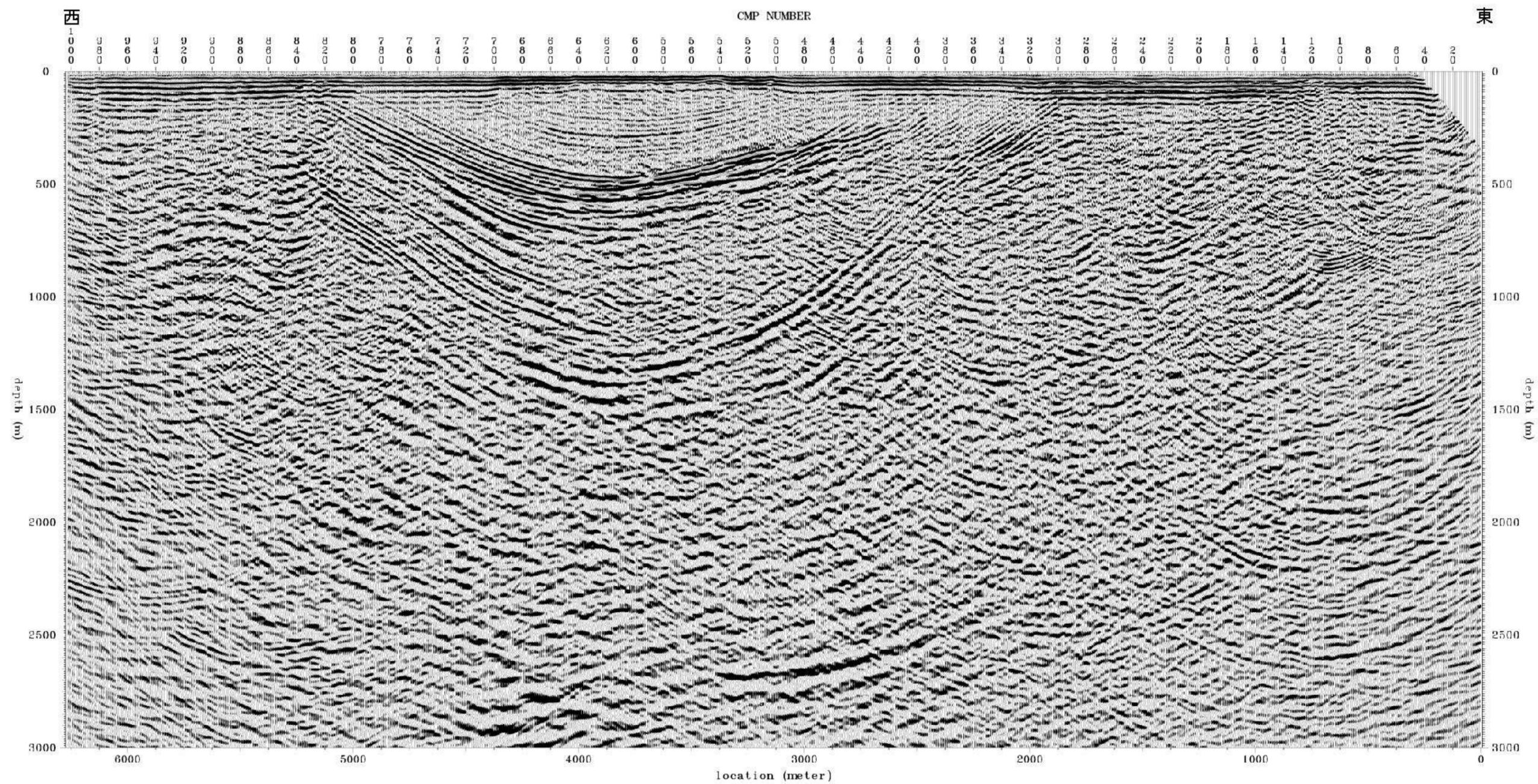
深度断面図 (P波探査 : 09B-6 測線)
