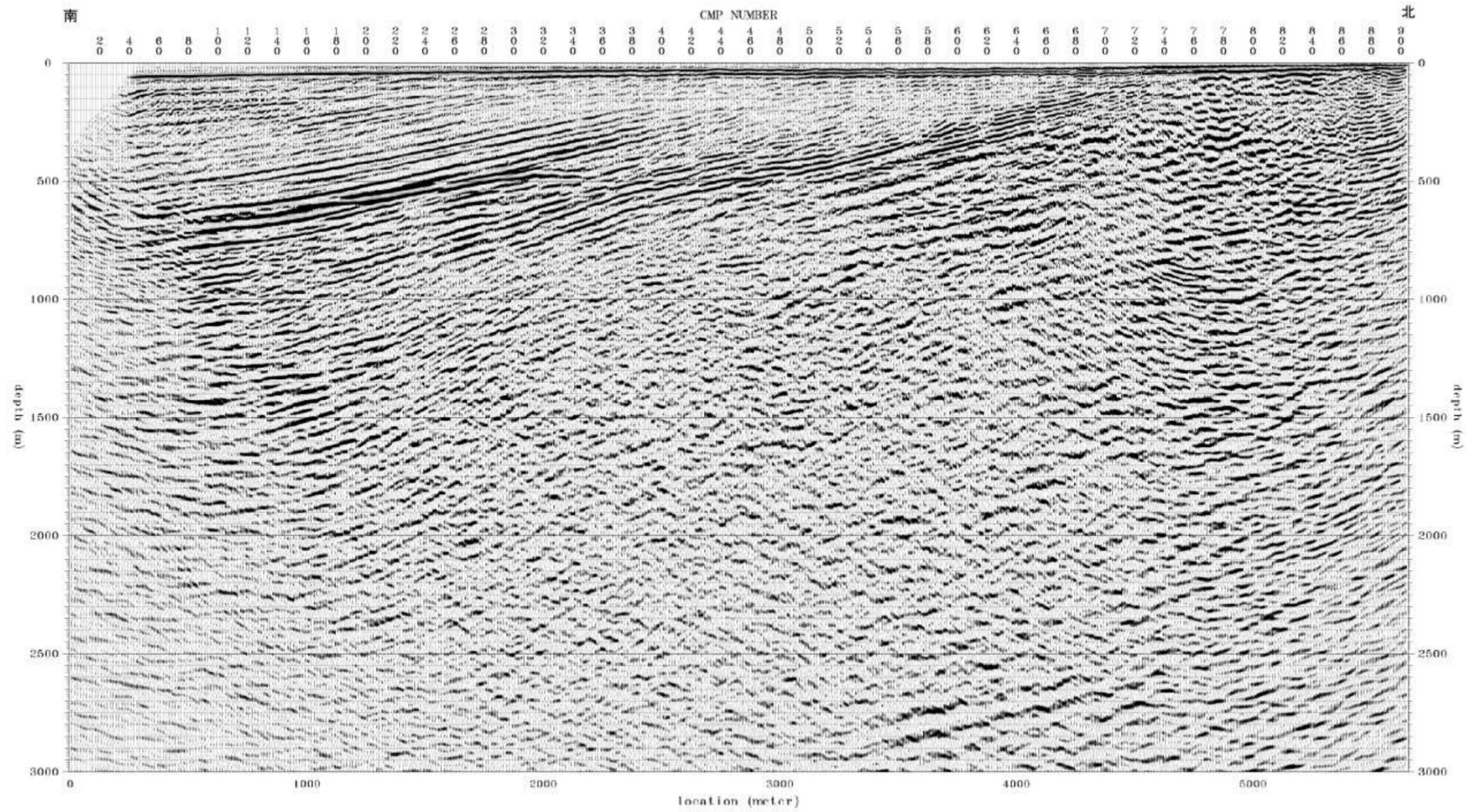
深度断面図（P波探査：09B-1 測線）
