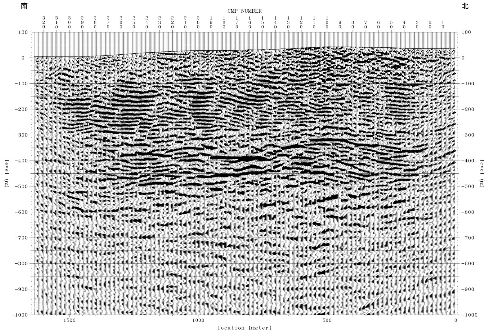
深度断面図 (P波探査: R01 測線)
