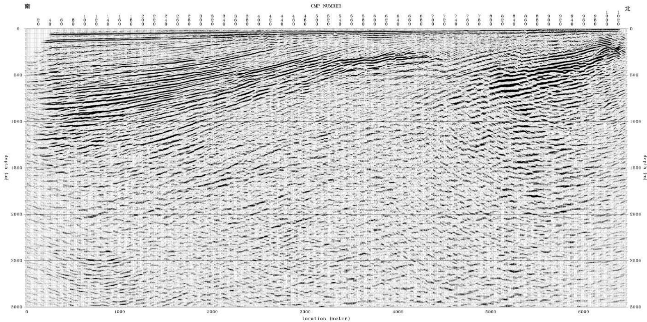
深度断面図 (P波探査 : 09B-3 測線)
