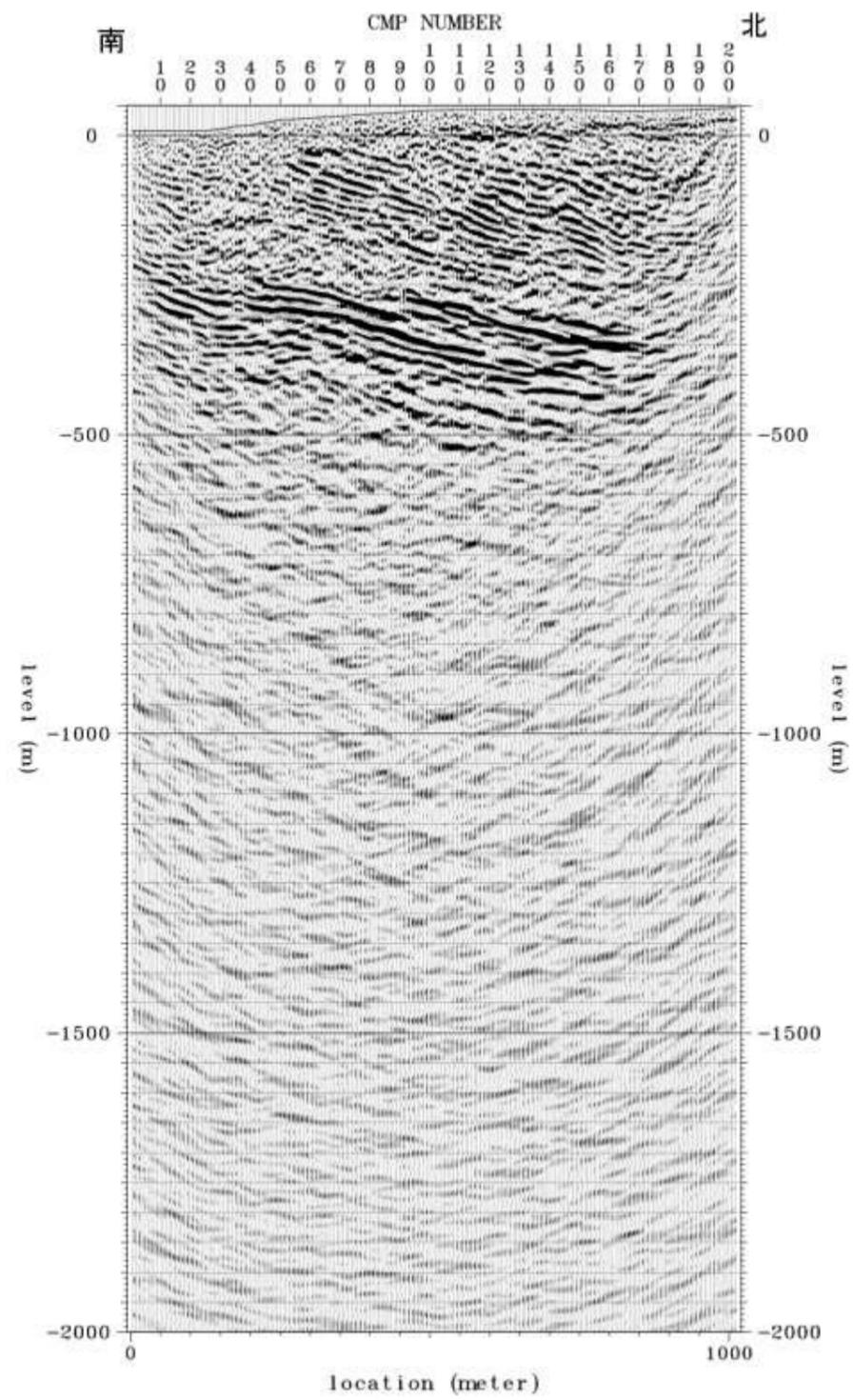
深度断面図 (P波探査: 2P 測線)
