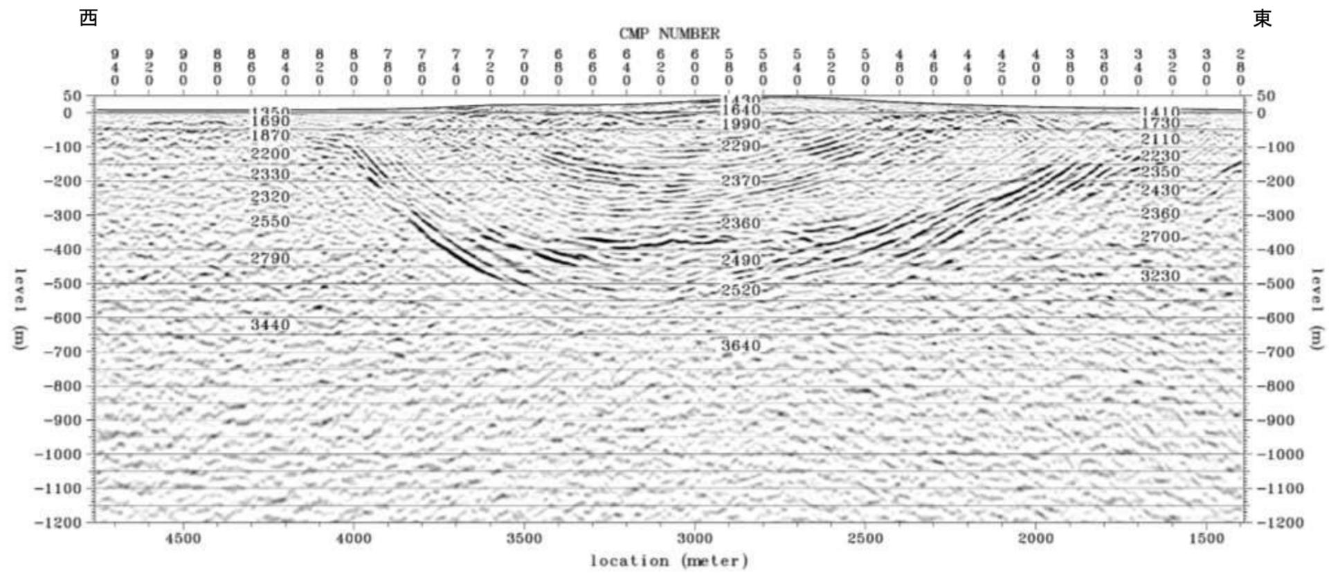
深度断面図（P波探査：P1A 測線、図中の数値は反射法速度解析結果から推定したその地点(数値中央)のP波速度(m/sec)
