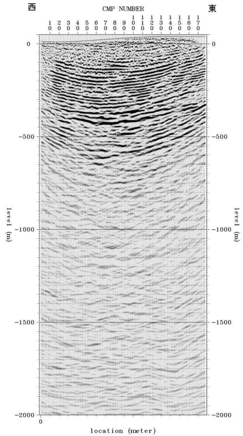
深度断面図 (P波探査 : 6P 測線)
