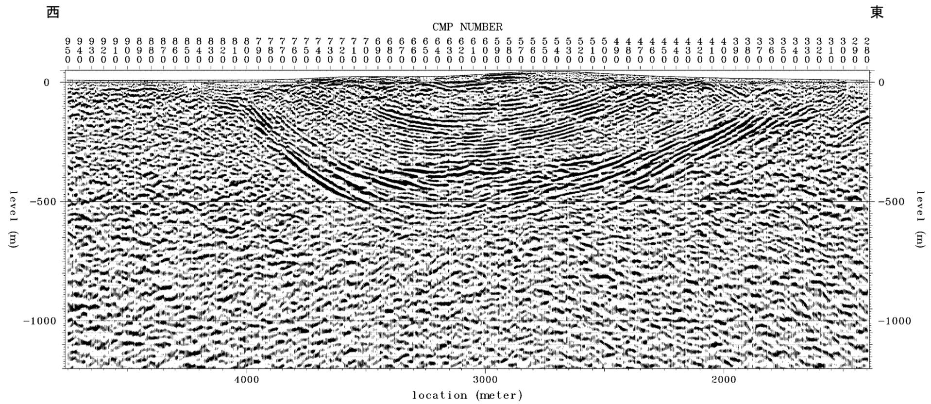
深度断面図 (P波探査: P1A 測線)
