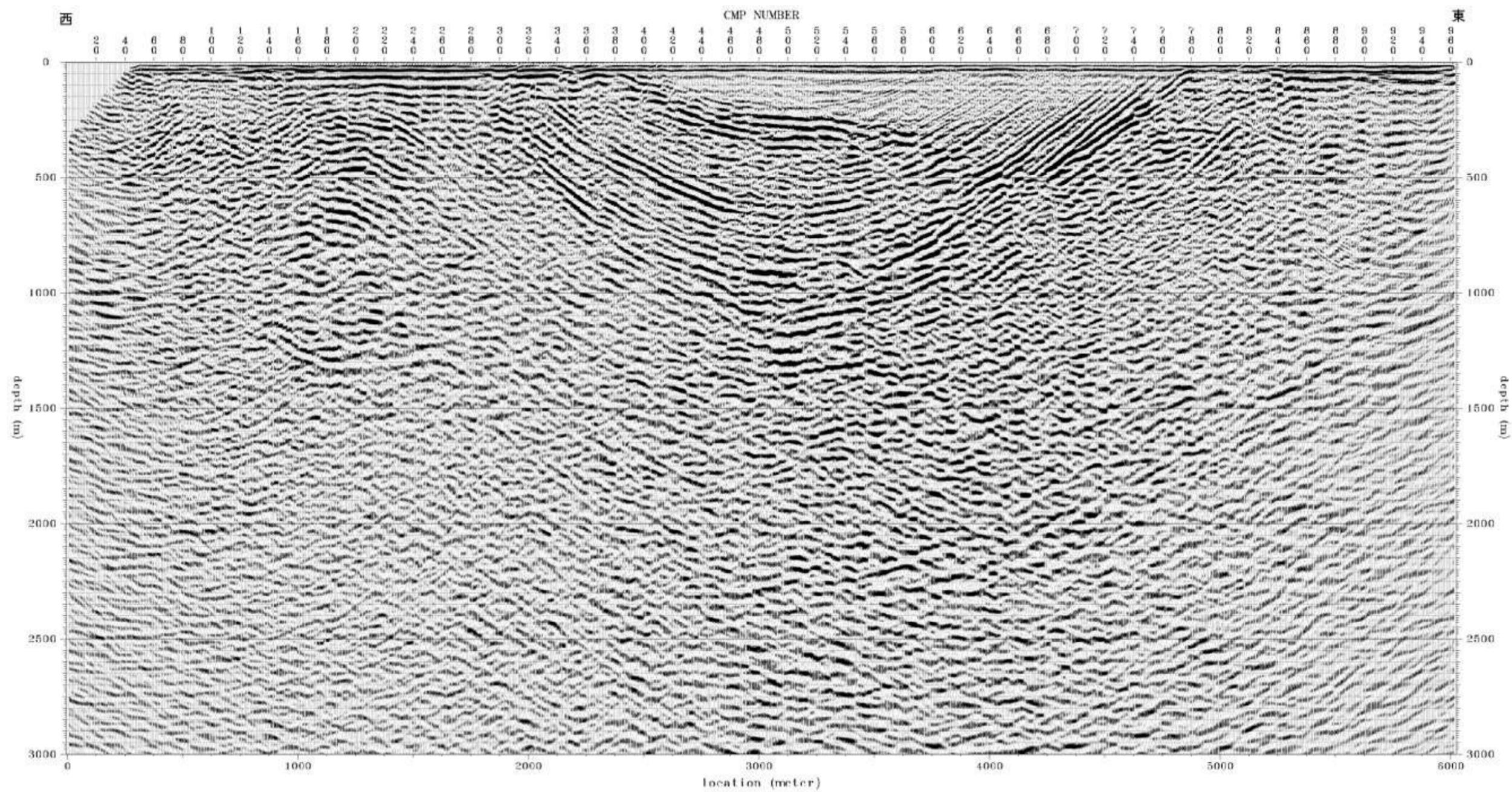
深度断面図 (P波探查 : 09B-5 測線)
