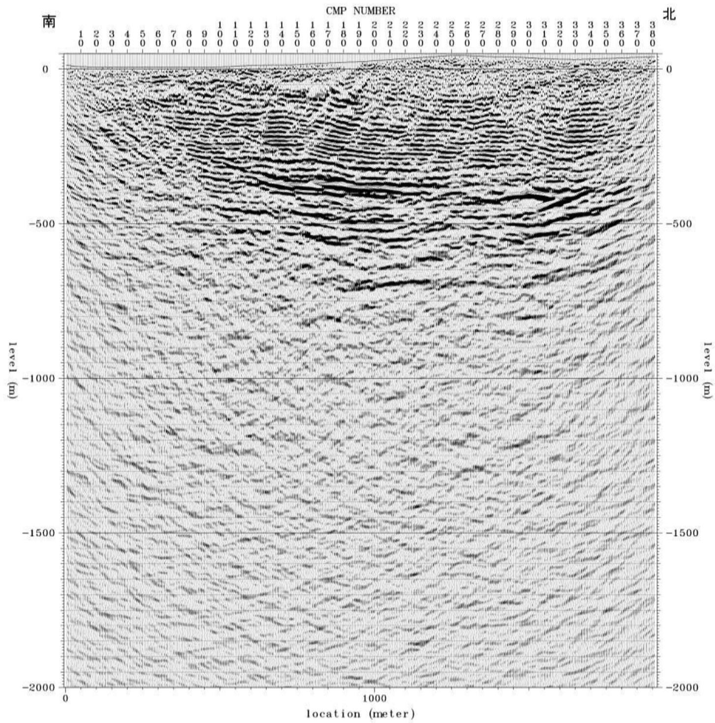
深度断面図 (P波探査: 1P 測線)
