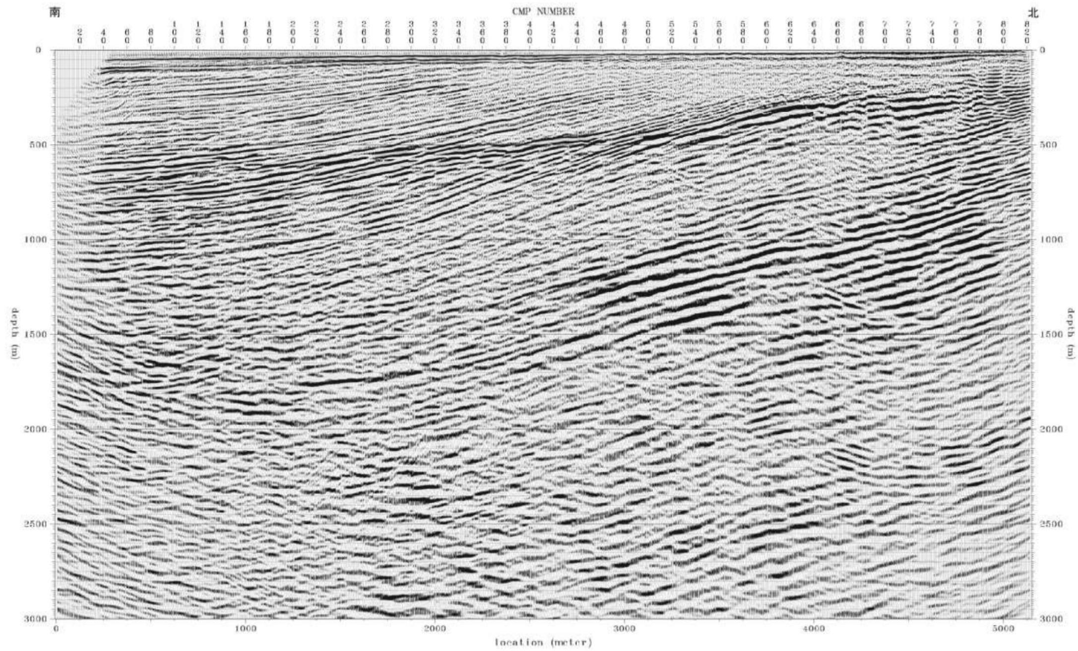
深度断面図（P波探査：09B-2 測線）
