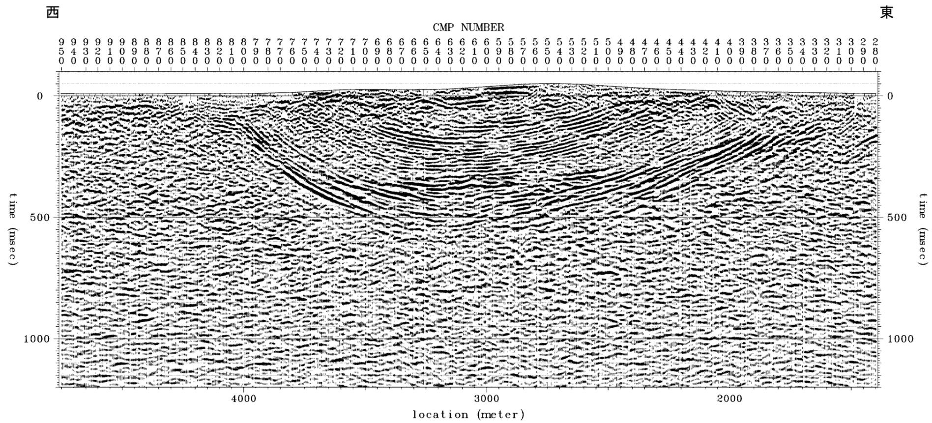
マイグレーション後時間断面図 (P波探査: P1A 測線)
