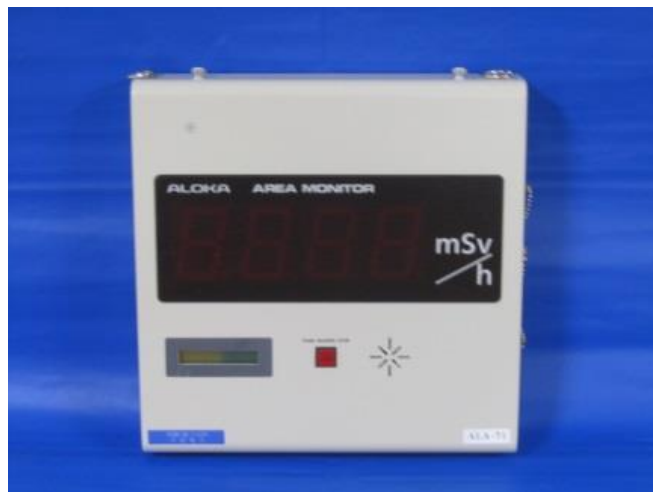
第 61-5-12 図 可搬式エリア放射線モニタの外観図
