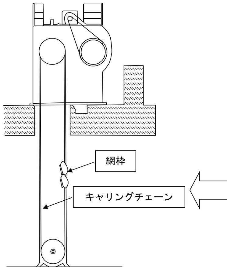
図-2-5-45 除塵装置の評価対象部位
