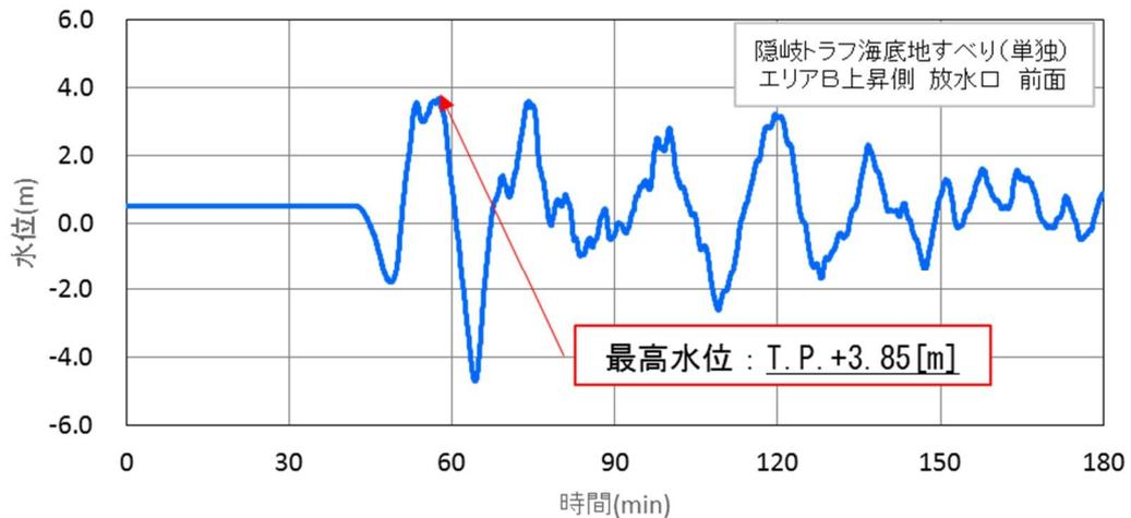
図-1 ①エリアB Kinematic モデル上昇側の津波水位—放水口前面—
