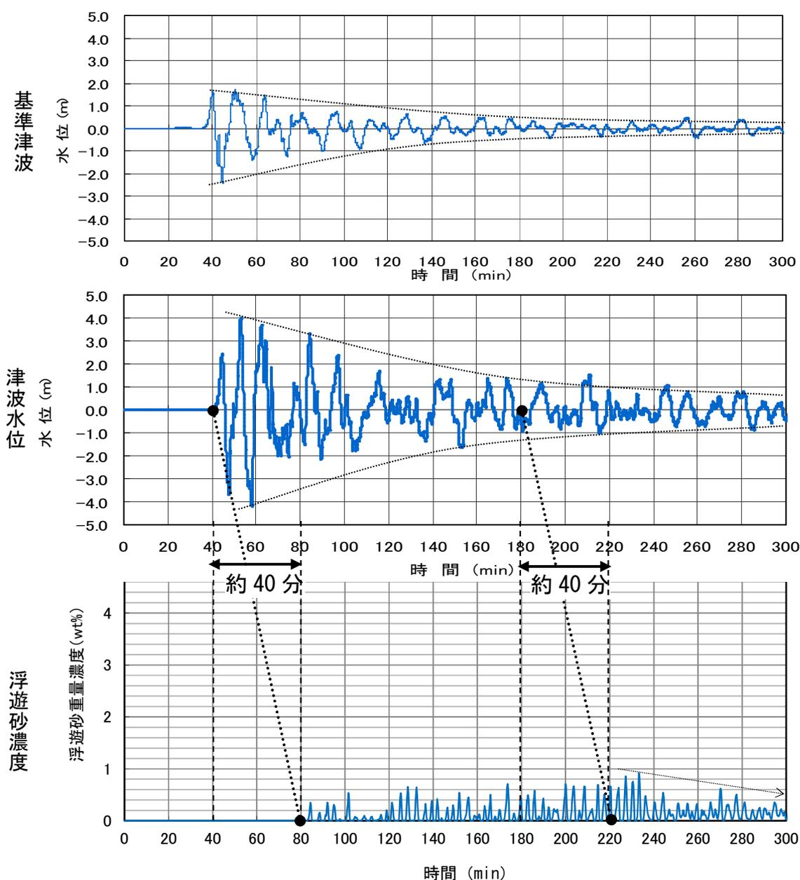
「基準津波 1 (若狭海丘列付近断層と隠岐トラフ海底地すべり (エリア B))
