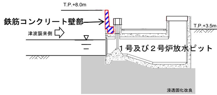
図-3-1-7 鉄筋コンクリート壁部
