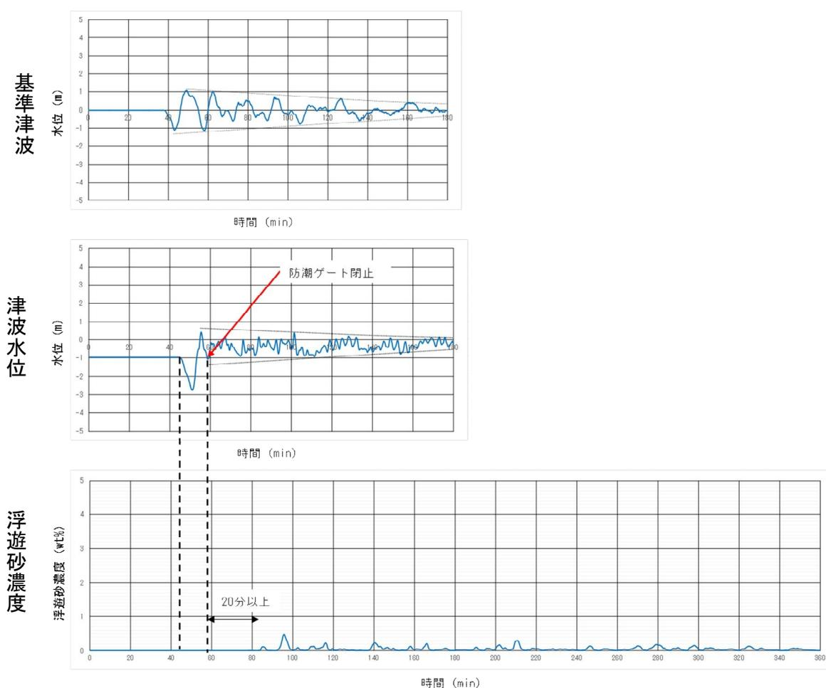
参考図 1 基準津波 3 (隠岐トラフ海底地すべり (エリア B))
