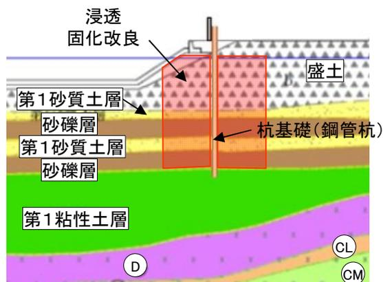
図-3-1-6 杭基礎形式部地盤改良範囲図
