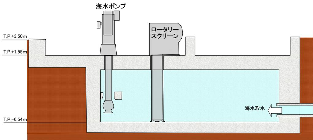
図-2-5-44 除塵装置概略図
