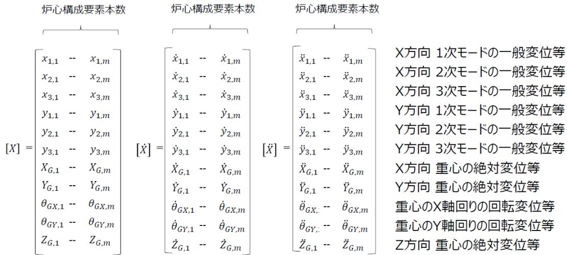
図 3.3 変位, 速度, 加速度マトリクスの構成
