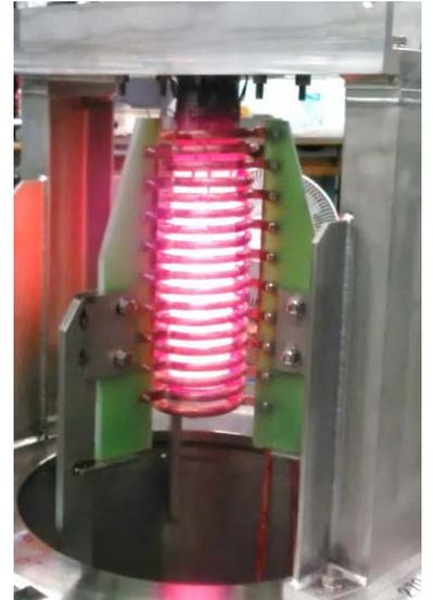
図-7 流下ノズルの加熱状況
