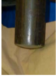
60分保持後、シール材部より水漏れのないことを確認
