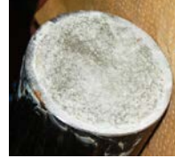
60分保持後、モルタル部からの水漏れ及びびにじみなし
