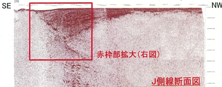
図 3.3.9-7 J測線(山本・他、1992)の再解析結果深度断面(右が北、振幅 Hilbert 変換表示、縦約2倍)、CDP(最上部の番号)2400から2150に掛けて地傾斜が大きく変形し、基岩は三波川変成岩類と領家花崗岩類の会合部に収斂する。さらに、会合部付近にて三波川変成岩類上面に食い違いが見られる。
