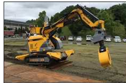
遠隔無人重機（BROKK）
