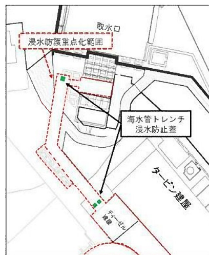
図-3-2-1 海水ポンプ室等浸水防止設備
