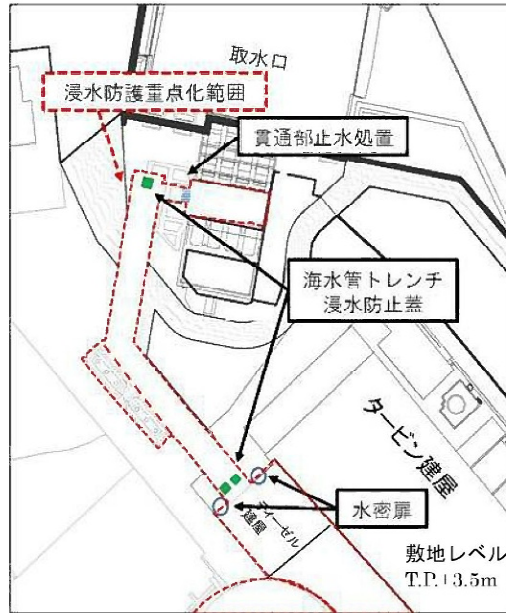
図-2-4-16 浸水対策設置箇所
