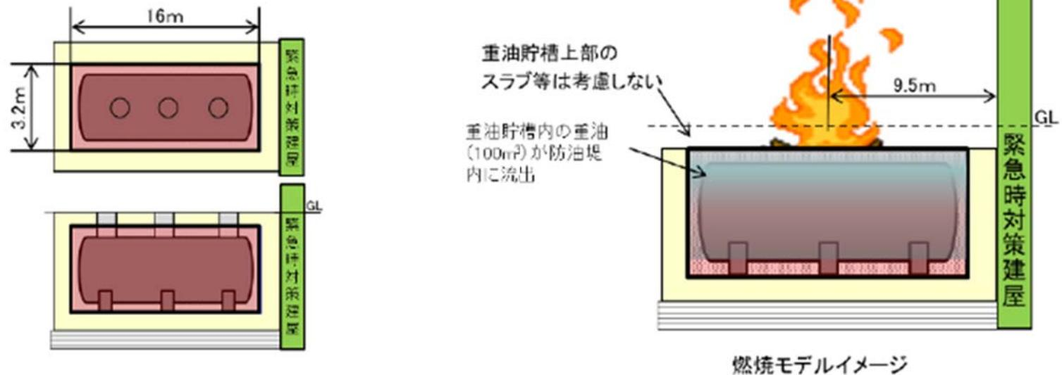
第 2.9.2-1 図 重油貯槽火災時の緊急時対策建屋への
