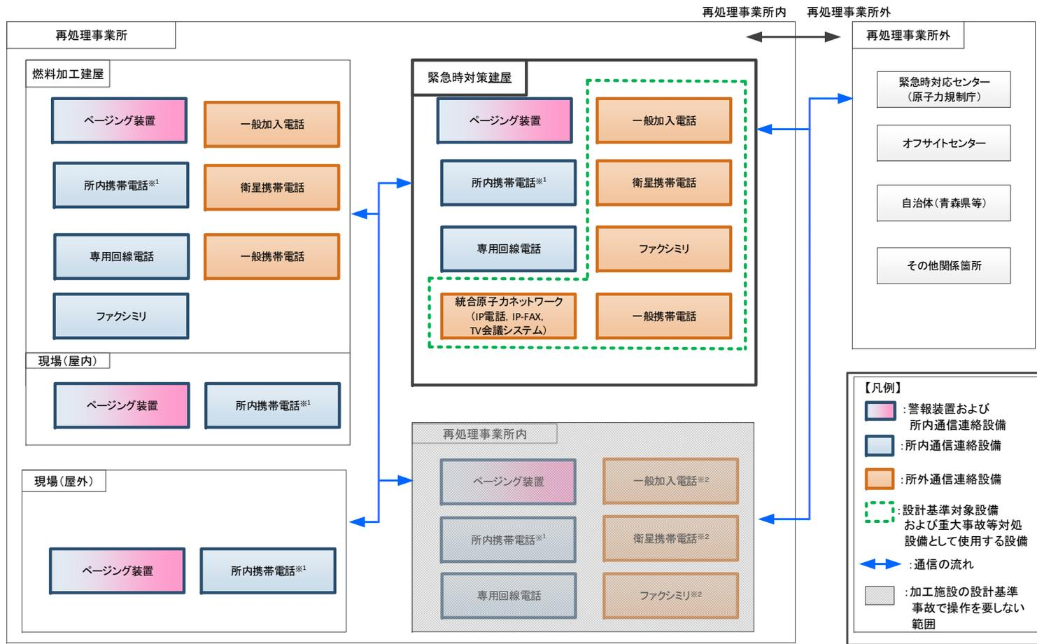
※1: 加入電話設備に接続されており、再処理事業所外への通信連絡が可能である。 ※2: 制御建屋に設置
