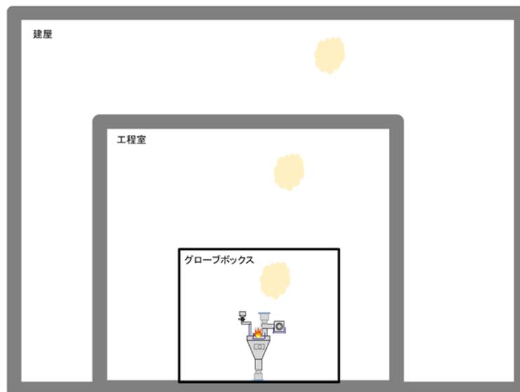
緊急時対策所の居住性評価モデル
