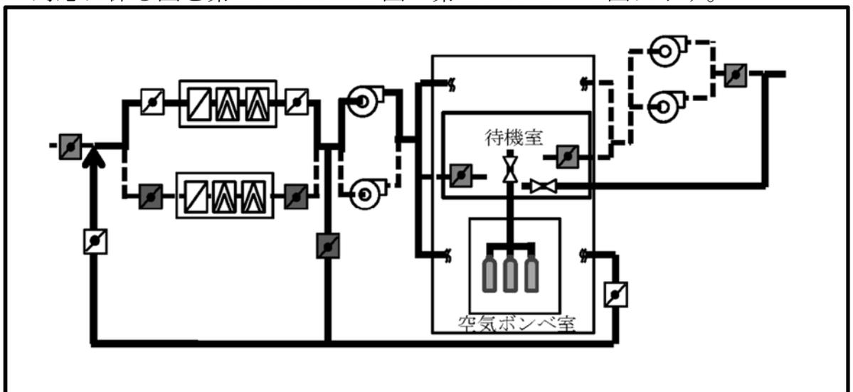
第2.1.4-2図 再処理施設において大規模な気体状の放射性物質の大気中への放出に至るおそれがある場合の換気設備概要図
