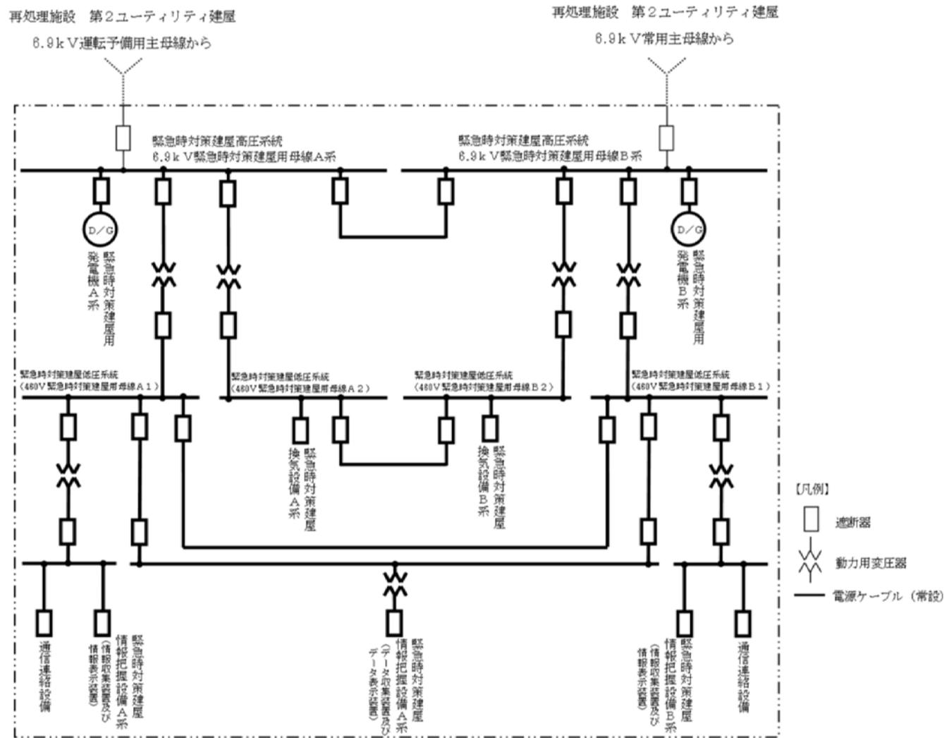
第 2.1.2-1 図 緊急時対策建屋 単線結線図
