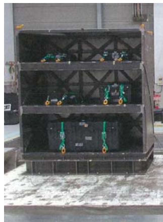
収納箱を保管棚に固縛した状態
